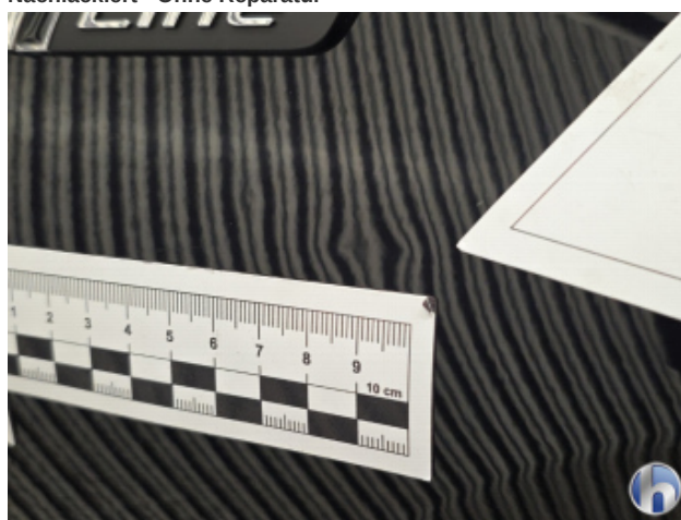
2. Kotflügel Vorne - Rechts 2 Dellen - Sanft Instandsetzen
