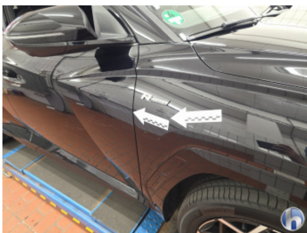
2. Kotflügel Vorne - Rechts 2 Dellen - Sanft Instandsetzen
