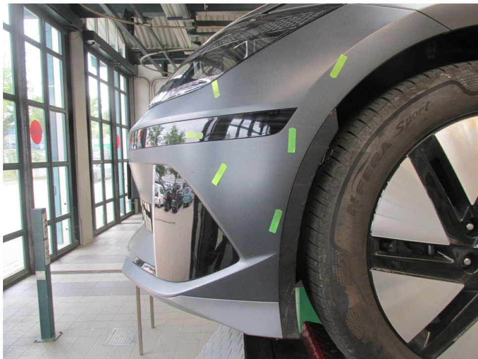
Bild 10 : leichte Streifschäden am vorderen Stoßfänger links
