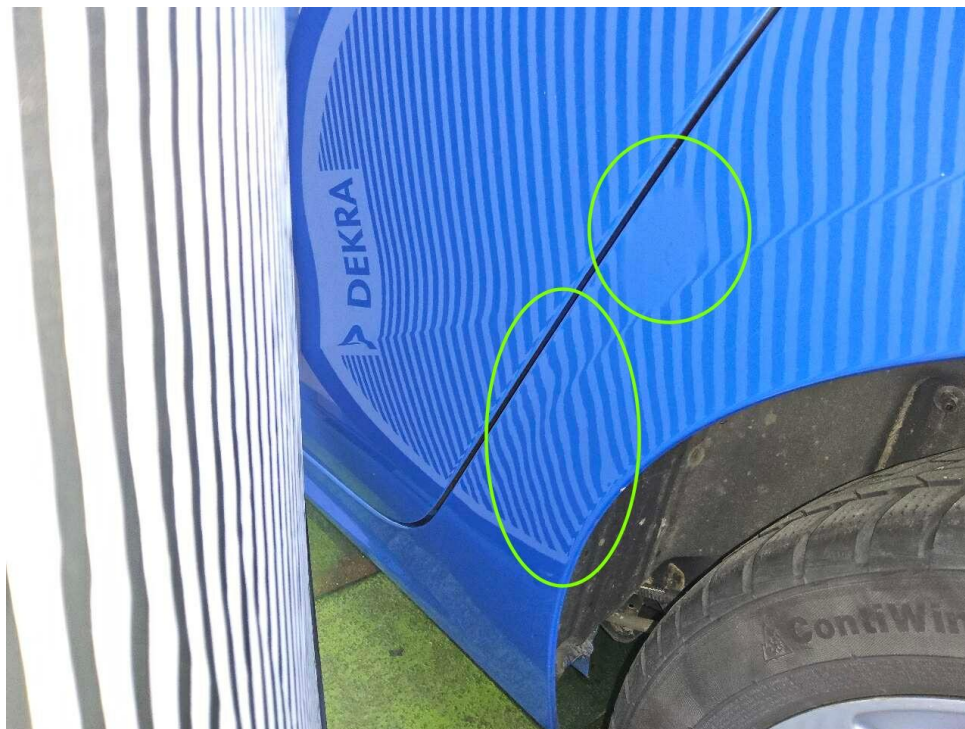
Bild 19 : Seitenteil links, eingedellt/zerkratzt
