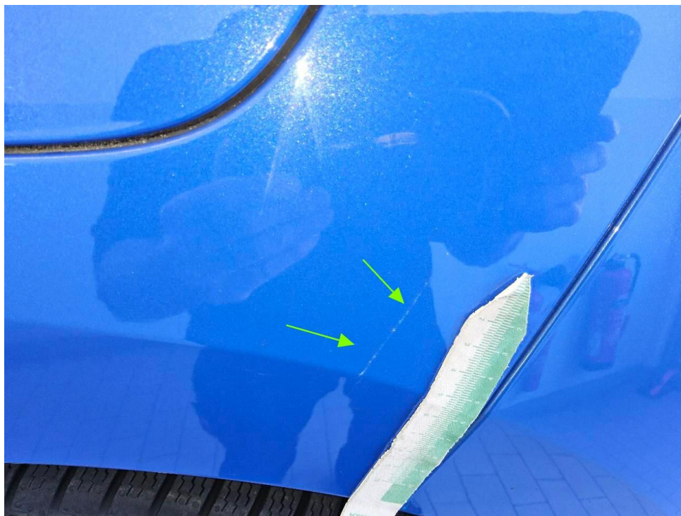
Bild 18 : Seitenteil links, eingedellt/zerkratzt
