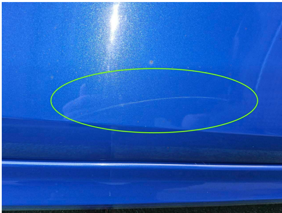
Bild 21 : Tür vorne rechts, zerkratzt
