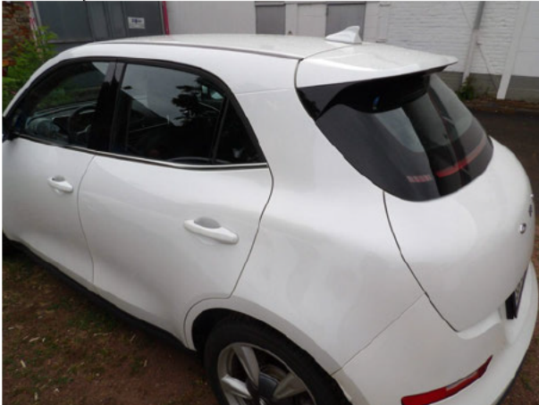
Beschädigung #8: Seitenwand links: Seitenwand - Delle(n) - sanft instandsetzen
