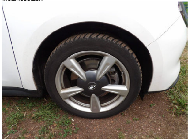
Beschädigung #9: Rad/Reifen: Leichtmetallfelge vorn rechts (Materialabtrag) - verkratzt / verschürft - erneuern
