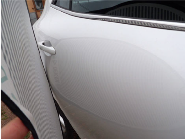
Beschädigung #4: Tür hinten rechts: Türkante - Kratzer - Smart Repair
