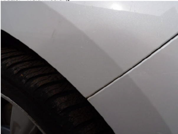
Beschädigung #2: Kotflügel rechts: Kotflügel rechts - Kratzer - Smart Repair
