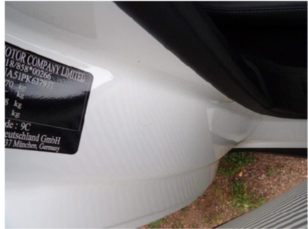
Beschädigung #5: Schweller rechts: Einstieg - Kratzer - Smart Repair
