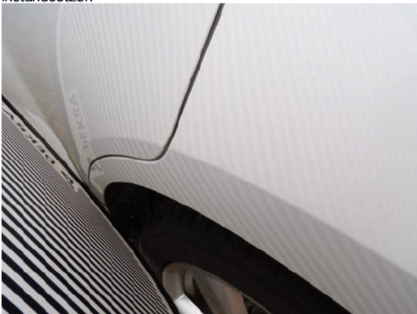
Beschädigung #8: Seitenwand links: Seitenwand - Delle(n) - sanft instandsetzen
