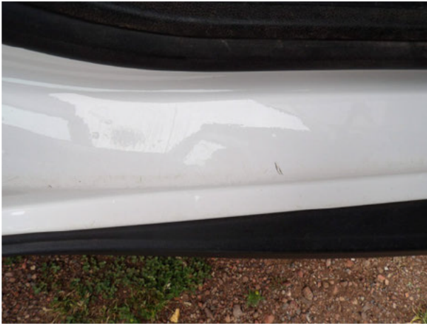
Beschädigung #5: Schweller rechts: Einstieg - Kratzer - Smart Repair
