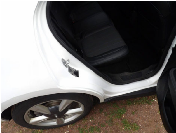
Beschädigung #5: Schweller rechts: Einstieg - Kratzer - Smart Repair
