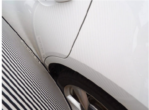
Beschädigung #8: Seitenwand links: Seitenwand - Delle(n) - sanft instandsetzen
