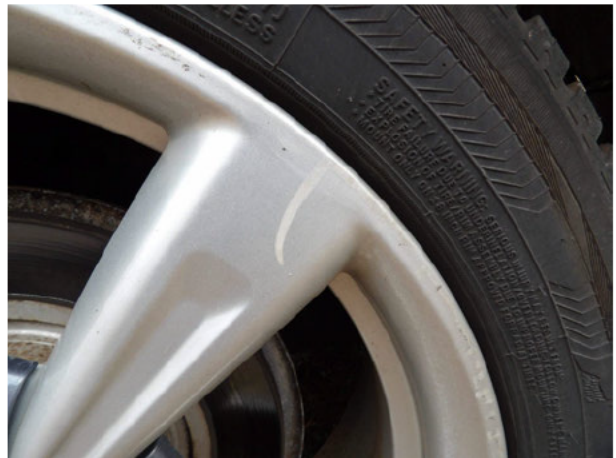
Beschädigung #1: Rad/Reifen: Leichtmetallfelge hinten rechts - Kratzer - Wertminderung
