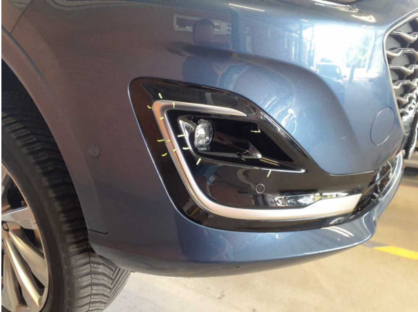
Beschädigung #2: Stossfänger vorn: Stossfänger vorn rechts (Blende inklusive Zierleiste) - verkratzt / verschürft - erneuern
