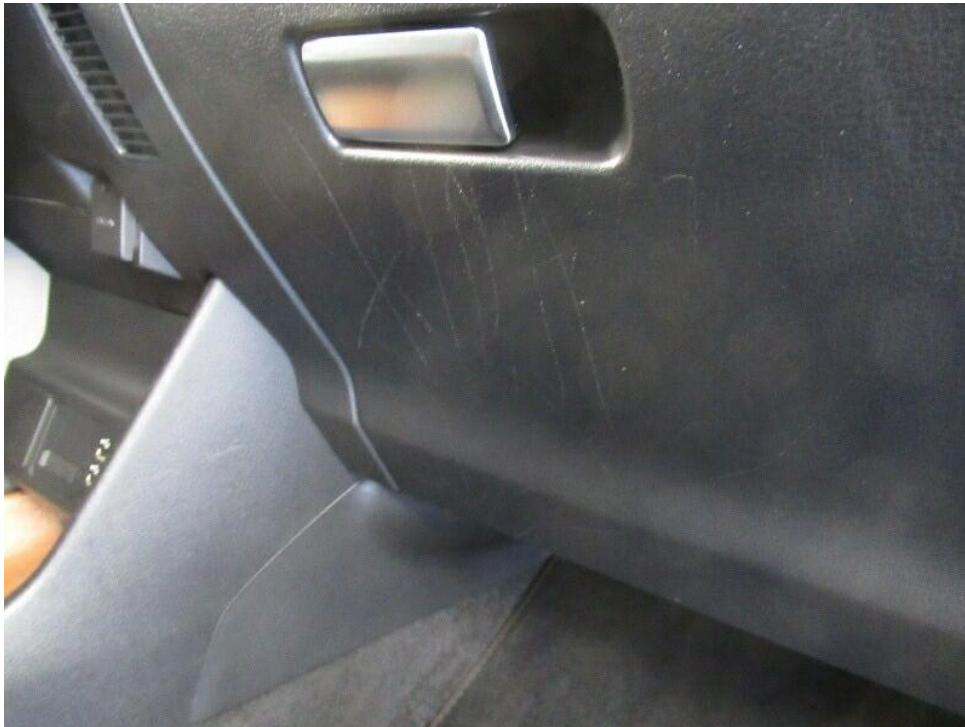
Bild 19 : Handschuhfachdeckel, zerkratzt, Gebrauchsspur
