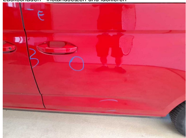
Beschädigung #13: Schiebetür links: Schiebetür mit Glasscheibe - Delle / Lackschaden - instandsetzen und
