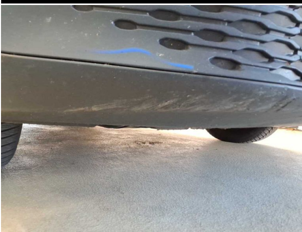
Beschädigung #7: Stossfänger vorn: Stossfänger vorn (unlackiert) - verkratzt / verschürft - Wertminderung
