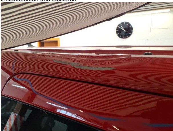
Beschädigung #12: Fahrzeugdach: Dachholm rechts - Delle / Lackschaden - instandsetzen und lackieren
