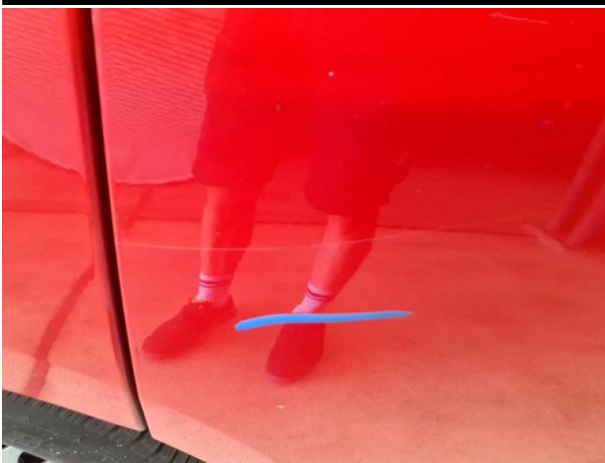
Beschädigung #14: Schiebetür rechts: Schiebetür mit Glasschei... - Delle / Lackschaden - instandsetzen und lackieren
