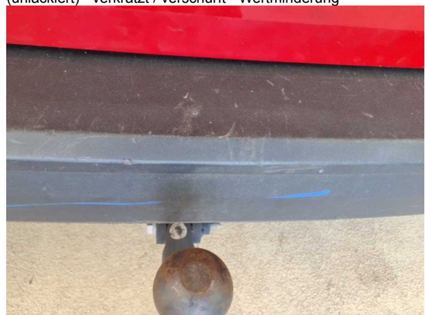
Beschädigung #10: Stossfänger hinten: Stossfänger hinten (unlackiert) - verkratzt / verschürft - Wertminderung
