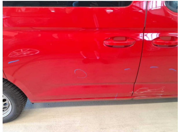
Beschädigung #14: Schiebetür rechts: Schiebetür mit Glasscheibe - Delle / Lackschaden - instandsetzen und
