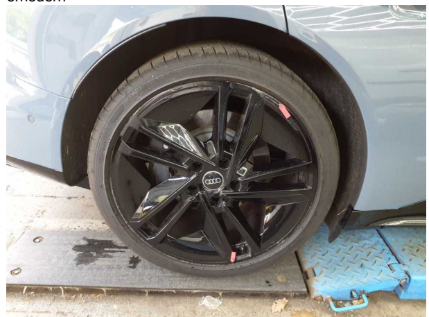
Beschädigung #6: Rad/Reifen: Leichtmetallfelge hinten rechts - Kratzer - erneuern
