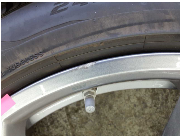
Beschädigung #4: 2.Radsatz: 2 Leichtmetallfelgen (Mit Reifenbeteiligung) - Kratzer - erneuern
