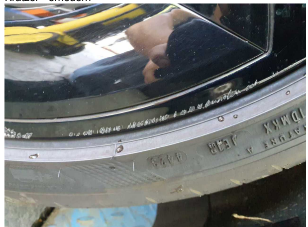
Beschädigung #6: Rad/Reifen: Leichtmetallfelge hinten rechts - Kratzer - erneuern
