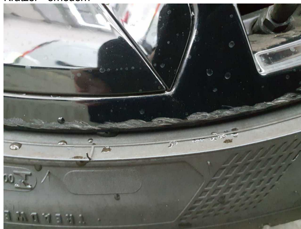
Beschädigung #8: Rad/Reifen: Leichtmetallfelge vorn rechts - Kratzer - erneuern
