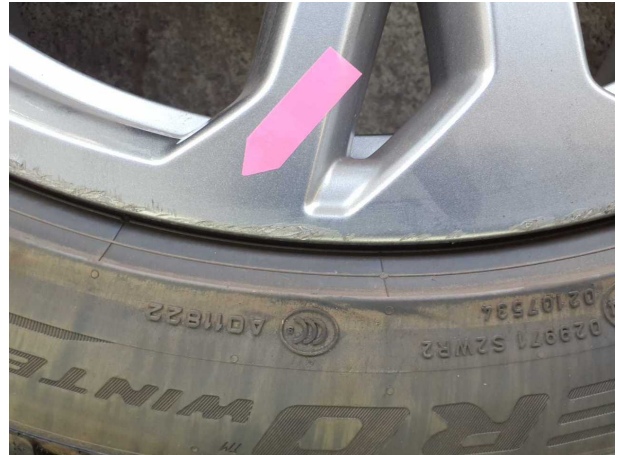
Beschädigung #9: 2.Radsatz: 1 Leichtmetallfelge (Felge 4. 2. Radsatz) - Kratzer - erneuern
