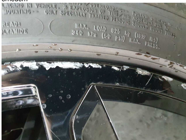
Beschädigung #8: Rad/Reifen: Leichtmetallfelge vorn rechts - Kratz... erneuern
