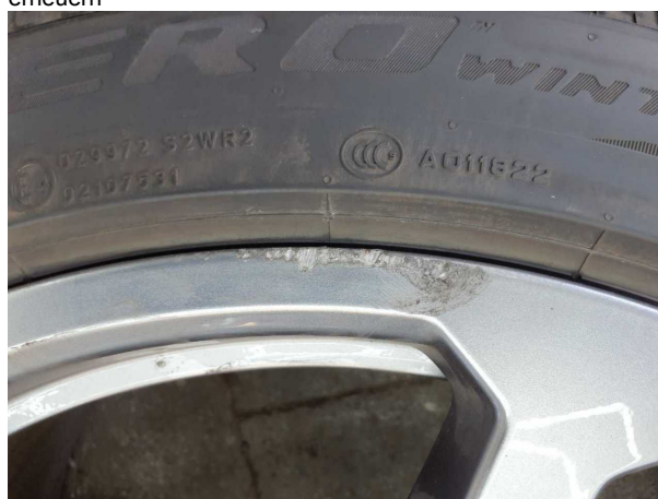
Beschädigung #3: 2.Radsatz: 1 Leichtmetallfelge - Kratzer - erneuern
