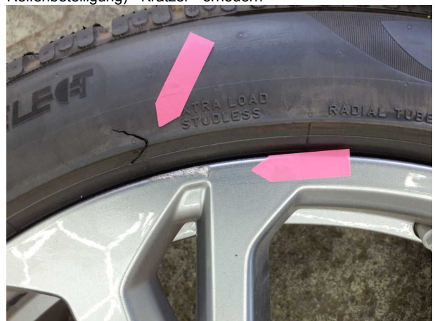
Beschädigung #4: 2.Radsatz: 2 Leichtmetallfelgen (Mit Reifenbeteiligung) - Kratzer - erneuern
