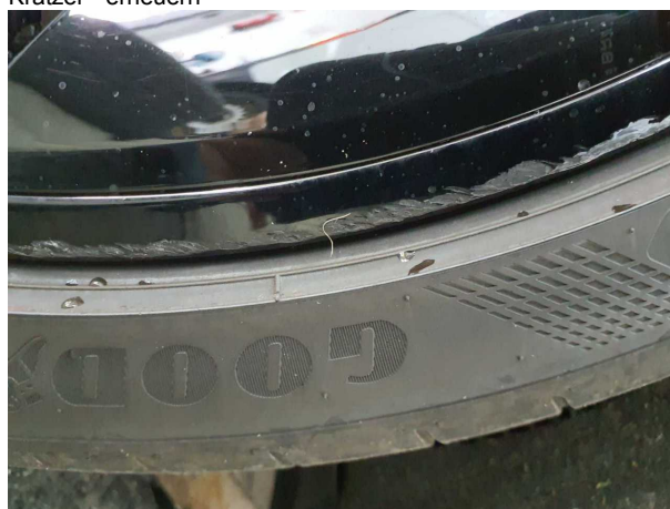
Beschädigung #8: Rad/Reifen: Leichtmetallfelge vorn rechts - Kratzer - erneuern
