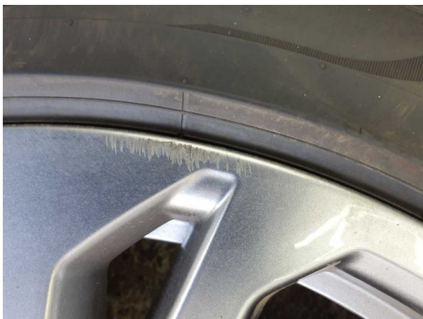
Beschädigung #5: 2.Radsatz: 3 Leichtmetallfelgen - Kratzer - erneuern
