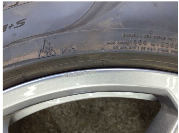
Beschädigung #5: 2.Radsatz: 3 Leichtmetallfelgen - Kratzer - erneuern
