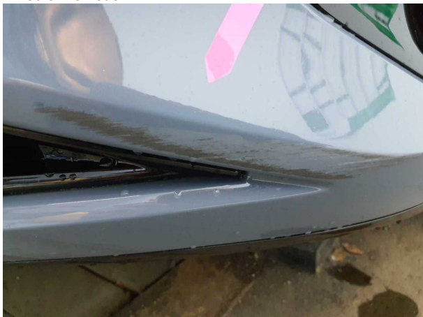
Beschädigung #10: Stoßfänger vorn: Stoßfänger vorn - verkratzt / verschürft - lackieren
