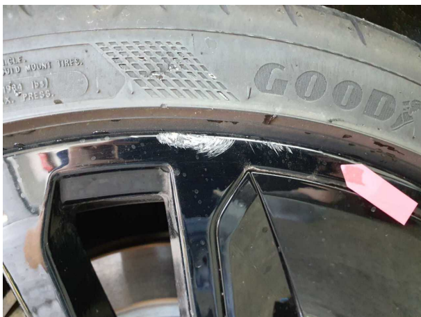
Beschädigung #6: Rad/Reifen: Leichtmetallfelge hinten rechts - Kratzer - erneuern
