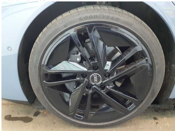
Beschädigung #7: Rad/Reifen: Leichtmetallfelge vorn links - Kratzer - erneuern
