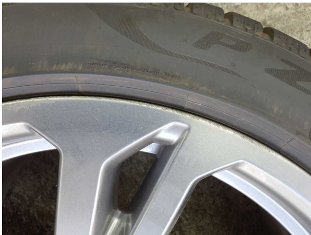
Beschädigung #5: 2.Radsatz: 3 Leichtmetallfelgen - Kratzer - erneuern
