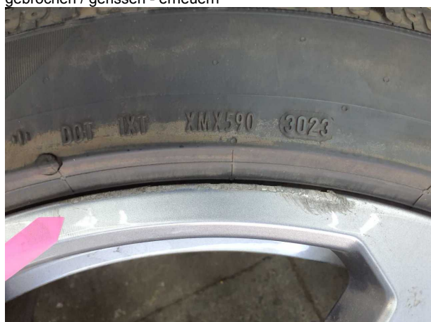
Beschädigung #3: 2.Radsatz: 1 Leichtmetallfelge - Kratzer - erneuern
