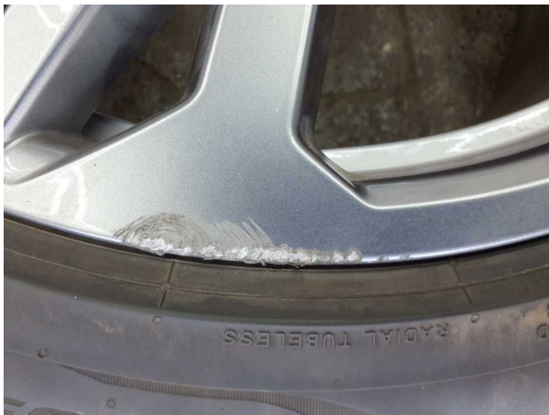
Beschädigung #3: 2.Radsatz: 1 Leichtmetallfelge - Kratzer - erneuern
