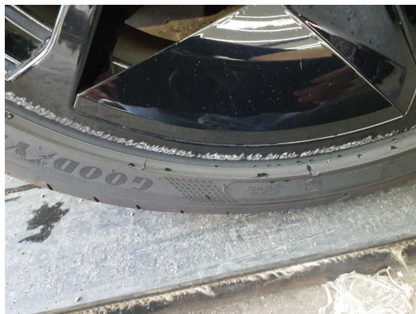
Beschädigung #6: Rad/Reifen: Leichtmetallfelge hinten rechts - Kratzer - erneuern
