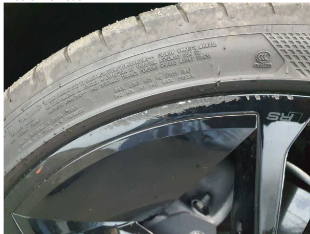
Beschädigung #7: Rad/Reifen: Leichtmetallfelge vorn links - Kratzer - erneuern
