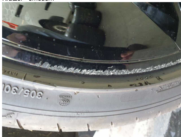
Beschädigung #6: Rad/Reifen: Leichtmetallfelge hinten rechts - Kratzer - erneuern
