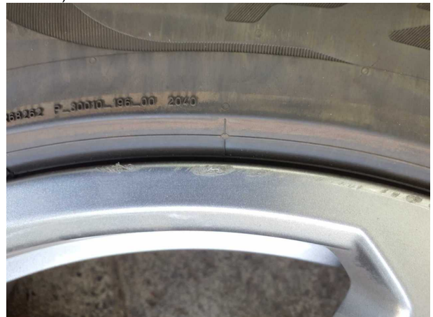
Beschädigung #9: 2.Radsatz: 1 Leichtmetallfelge (Felge 4. 2. Radsatz) - Kratzer - erneuern
