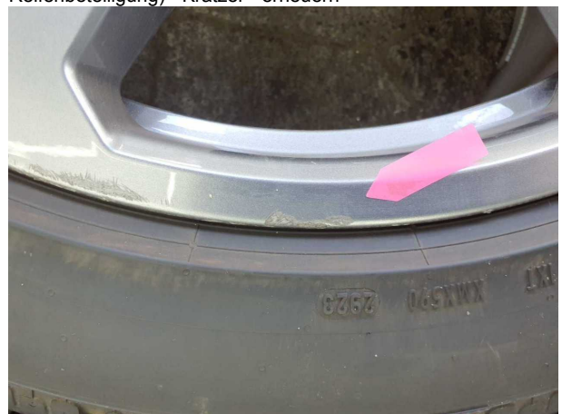
Beschädigung #5: 2.Radsatz: 3 Leichtmetallfelgen - Kratzer - erneuern
