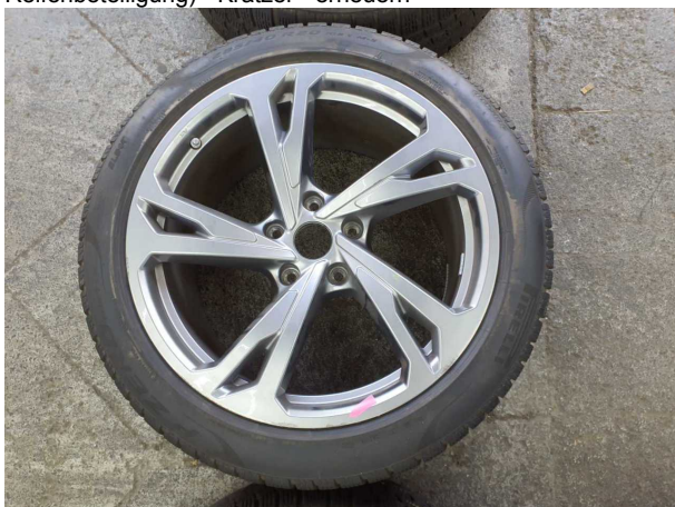
Beschädigung #5: 2.Radsatz: 3 Leichtmetallfelgen - Kratzer - erneuern
