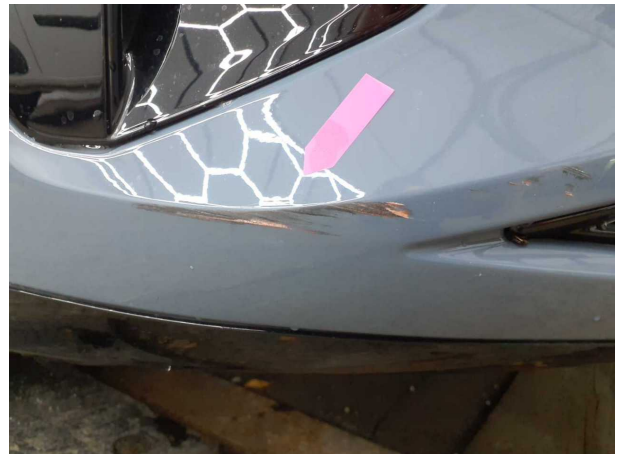
Beschädigung #10: Stossfänger vorn: Stossfänger vorn - verkratzt / verschürft - lackieren
