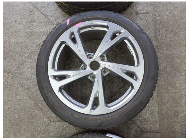
Beschädigung #4: 2.Radsatz: 2 Leichtmetallfelgen (Mit Reifenbeteiligung) - Kratzer - erneuern
