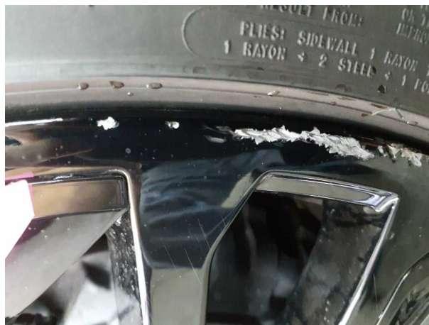
Beschädigung #8: Rad/Reifen: Leichtmetallfelge vorn rechts - Kratzer - erneuern
