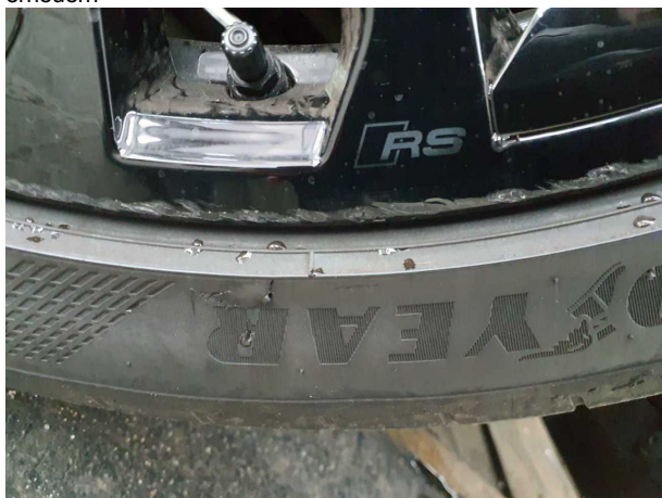
Beschädigung #8: Rad/Reifen: Leichtmetallfelge vorn rechts - Kratz... erneuern
