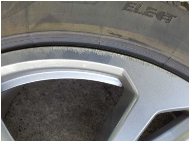
Beschädigung #9: 2.Radsatz: 1 Leichtmetallfelge (Felge 4. 2. Radsa... - Kratzer - erneuern
