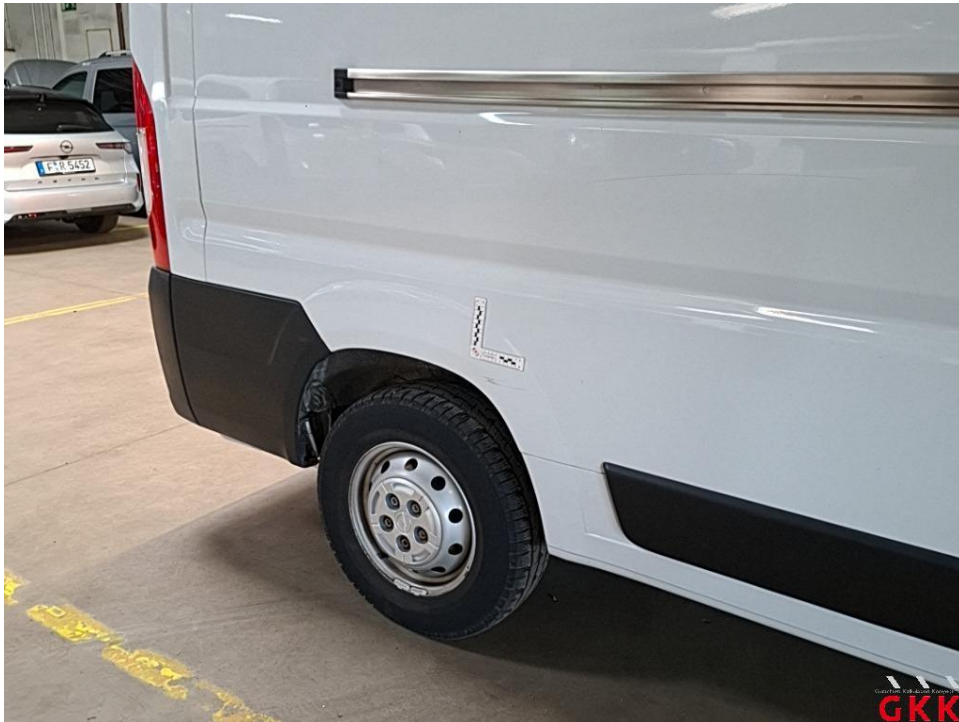
Bild 21 Seitenwand rechts, beschädigt, instand setzen - lackieren
