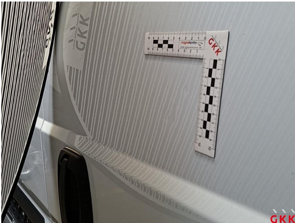
Bild 24 Hecktür rechts, beschädigt, instand setzen - lackieren
