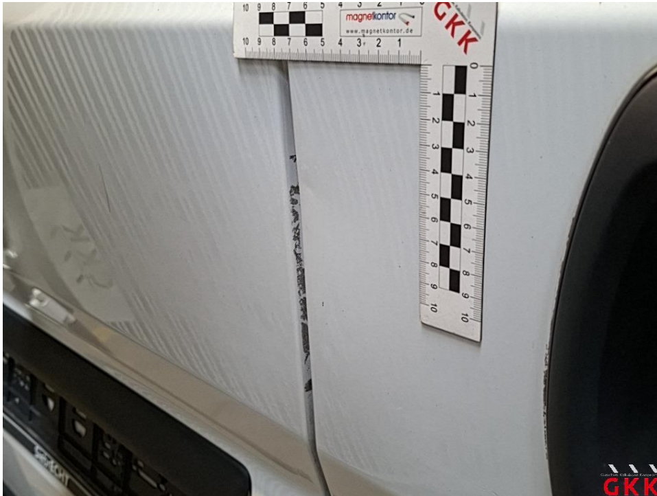
Bild 25 Hecktür rechts, beschädigt, instand setzen - lackieren
