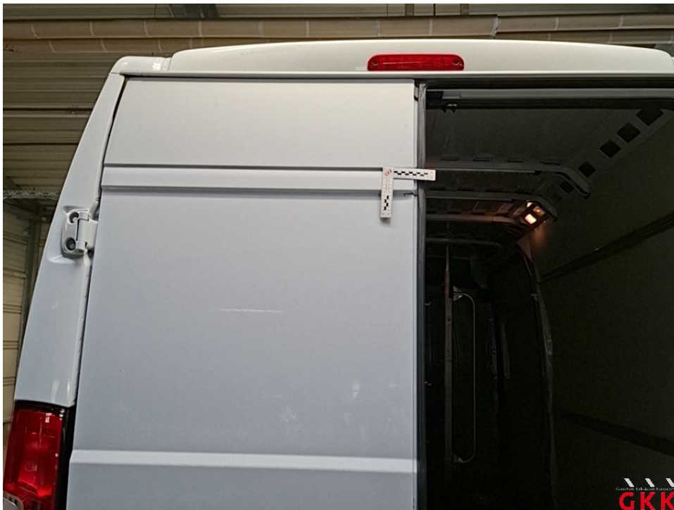
Bild 26 Hecktür links, beschädigt, ersetzen
