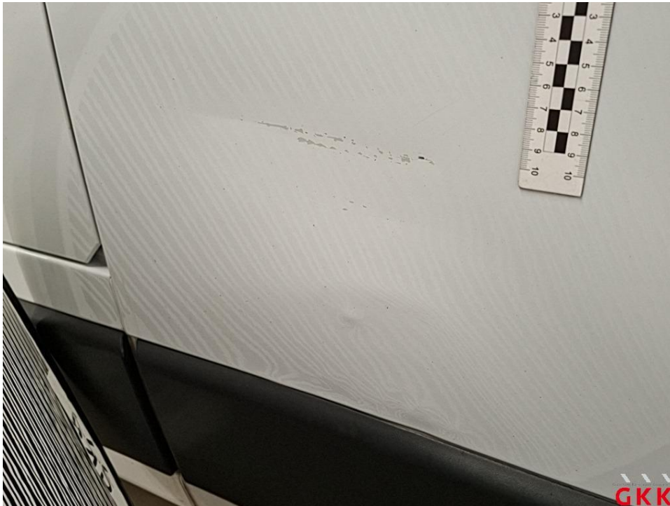
Bild 19 Seitenwand links, beschädigt, instand setzen - lackieren
