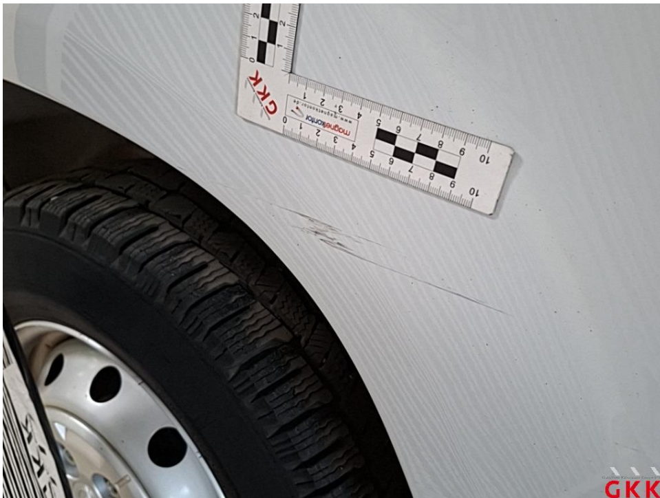
Bild 22 Seitenwand rechts, beschädigt, instand setzen - lackieren
