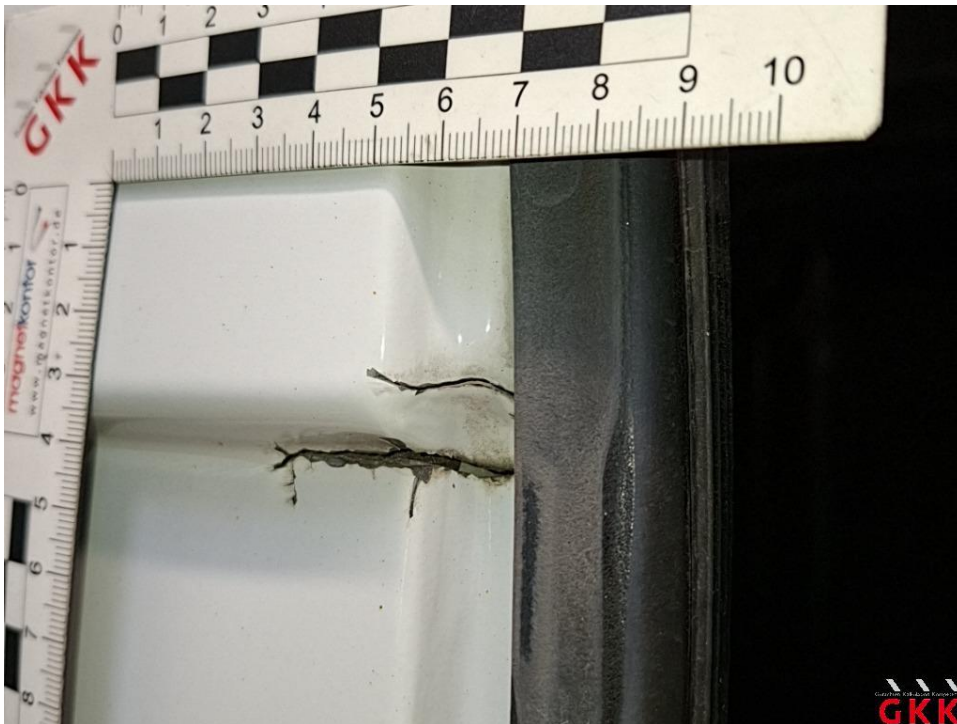
Bild 28 Hecktür links, beschädigt, ersetzen
