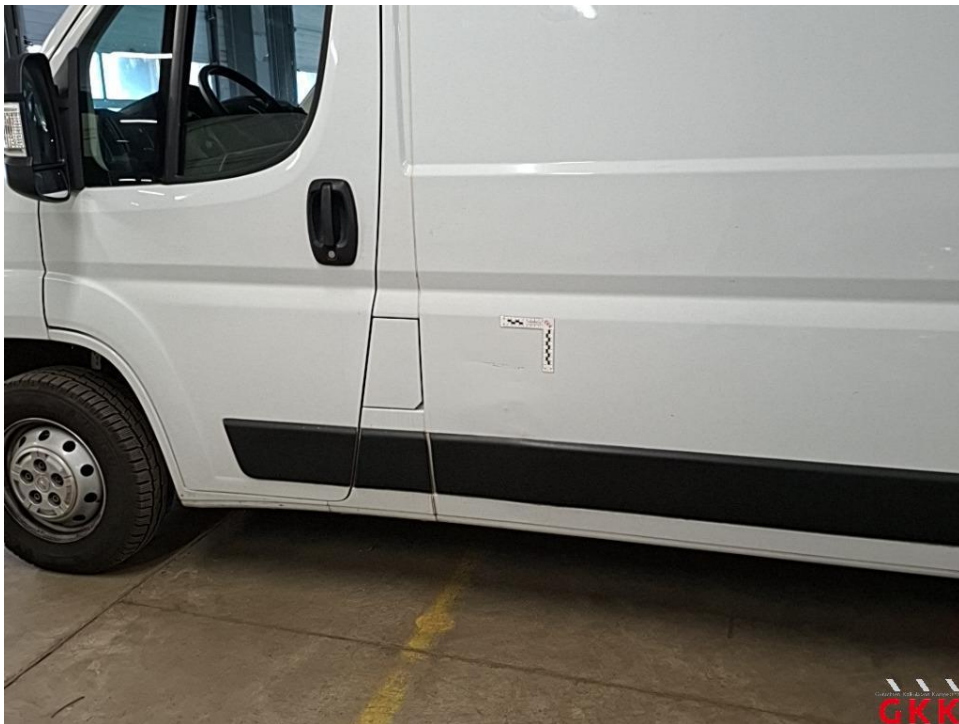
Bild 18 Seitenwand links, beschädigt, instand setzen - lackieren
