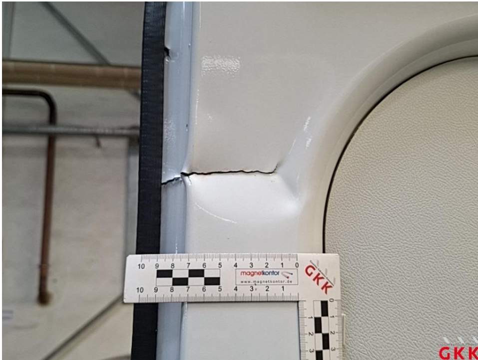
Bild 27 Hecktür links, beschädigt, ersetzen
