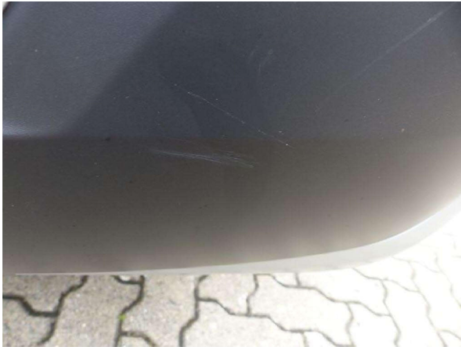
Bild 13 Gebrauchsspuren: Blende Stoßfängerverkleidung hinten verschrammt
