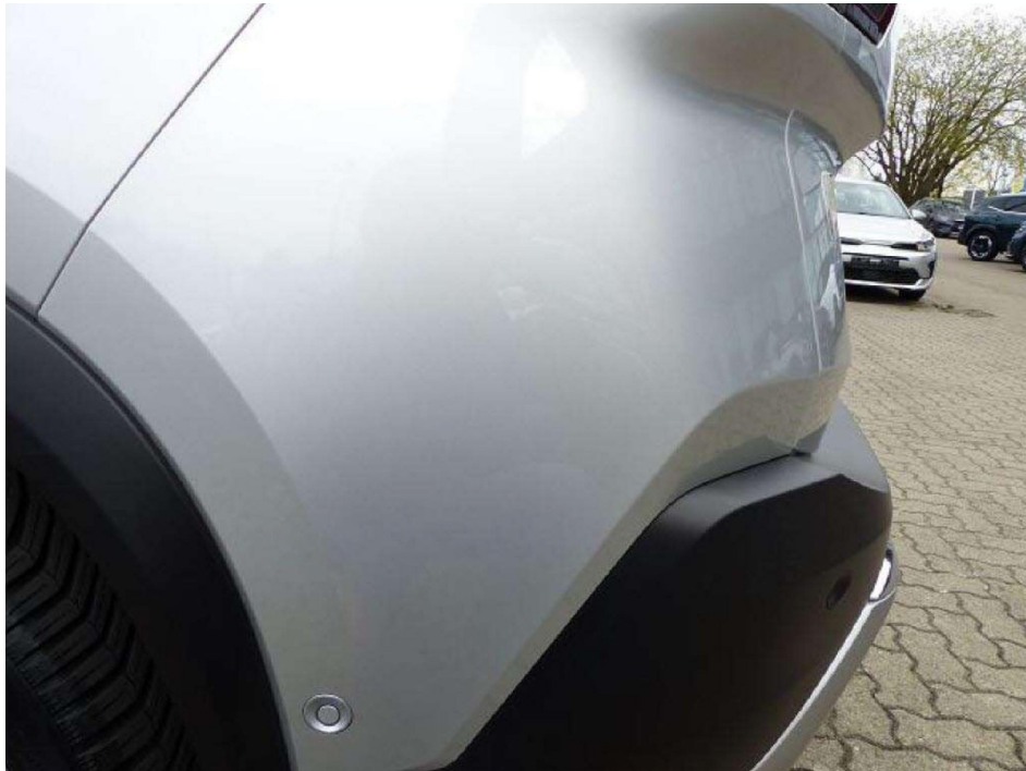
Bild 15 Gebrauchsspuren: Blende Stoßfängerverkleidung hinten verschrammt
