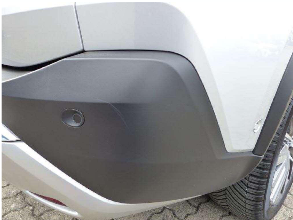
Bild 16 Gebrauchsspuren: Blende Stoßfängerverkleidung hinten verschrammt
