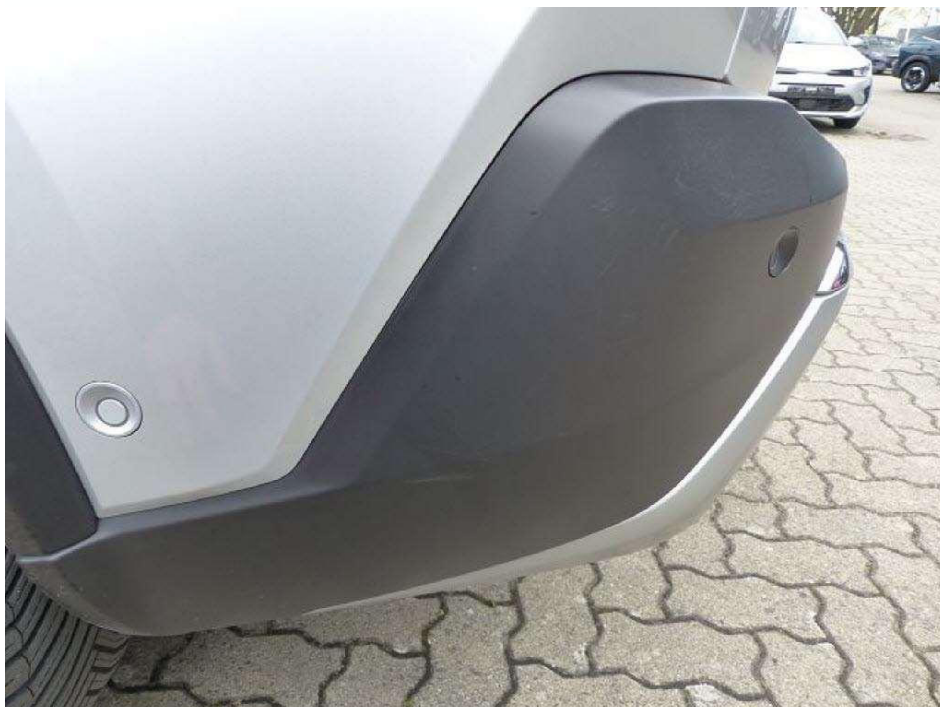
Bild 12 Gebrauchsspuren: Blende Stoßfängerverkleidung hinten verschrammt
