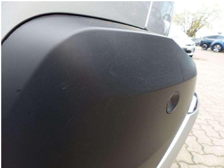
Bild 14 Gebrauchsspuren: Blende Stoßfängerverkleidung hinten verschrammt
