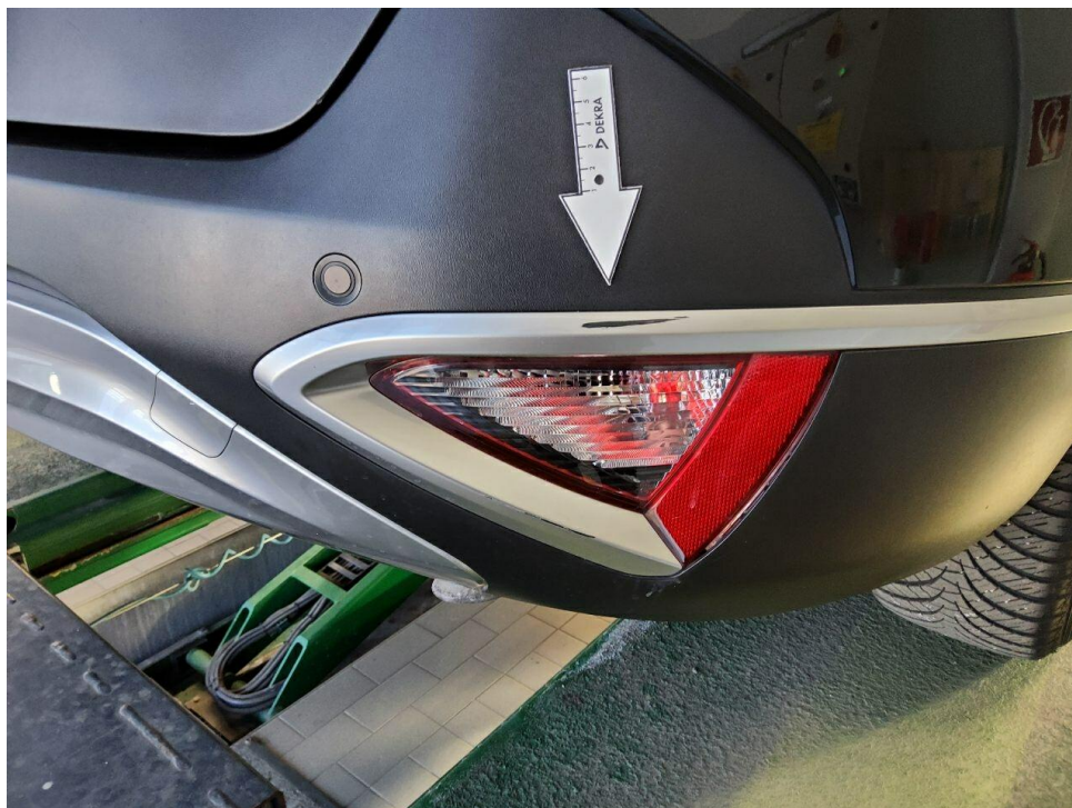
Bild 10 : Stoßfänger hinten, Zierleiste rechts, Lackierung zerkratzt / Spaltmaß erhöht
