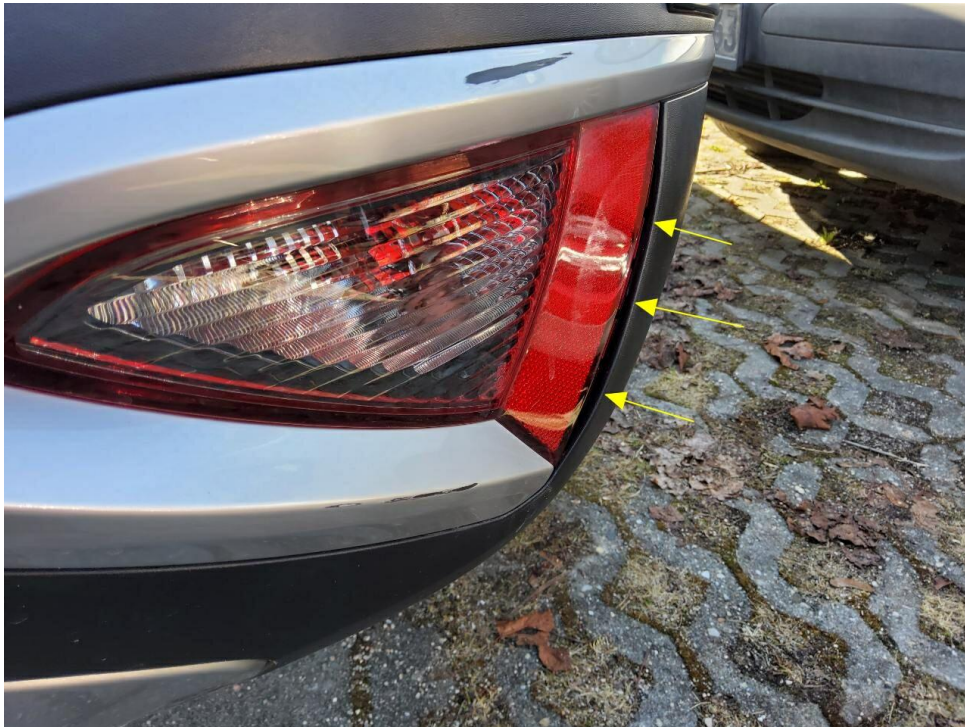
Bild 11 : Stoßfänger hinten, Zierleiste rechts, Lackierung zerkratzt / Spaltmaß erhöht
