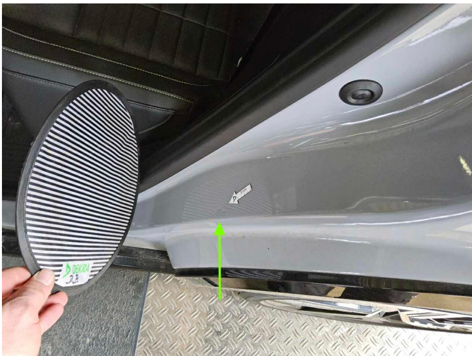
Bild 22 : Tür hinten links Einstieg, eingedellt, drücken
