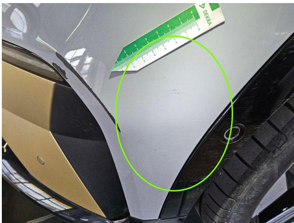
Bild 16 : Stoßfänger vorne und Radlaufblende vorne links zerkratzt
