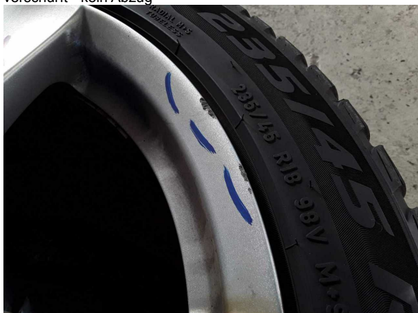
Beschädigung #1: 2.Radsatz: 2 Leichtmetallfelgen - verkratzt / verschürft - kein Abzug
