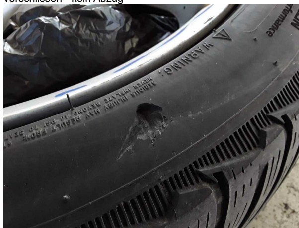
Beschädigung #2: 2.Radsatz: Reifensatz komplett - verschlissen - kein Abzug
