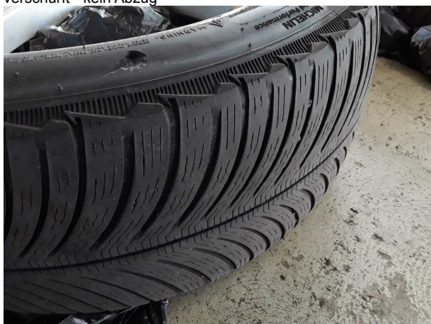
Beschädigung #2: 2.Radsatz: Reifensatz komplett - verschlissen - kein Abzug
