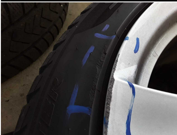
Beschädigung #2: 2.Radsatz: Reifensatz komplett - verschlissen - kein Abzug
