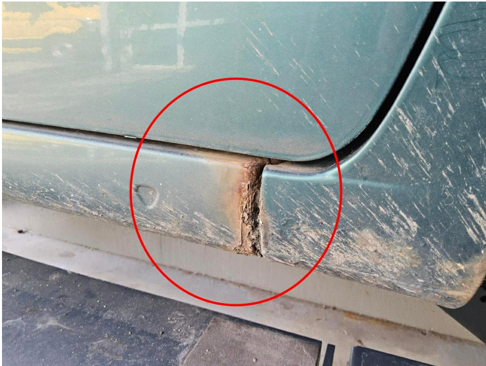
Bild 19 : Schweller rechts Rostansatz
