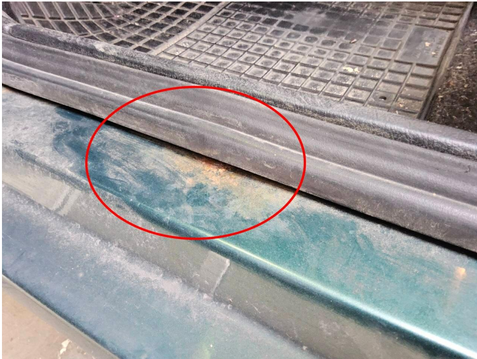
Bild 9 : Tür vorne links Einstieg Rostansatz
