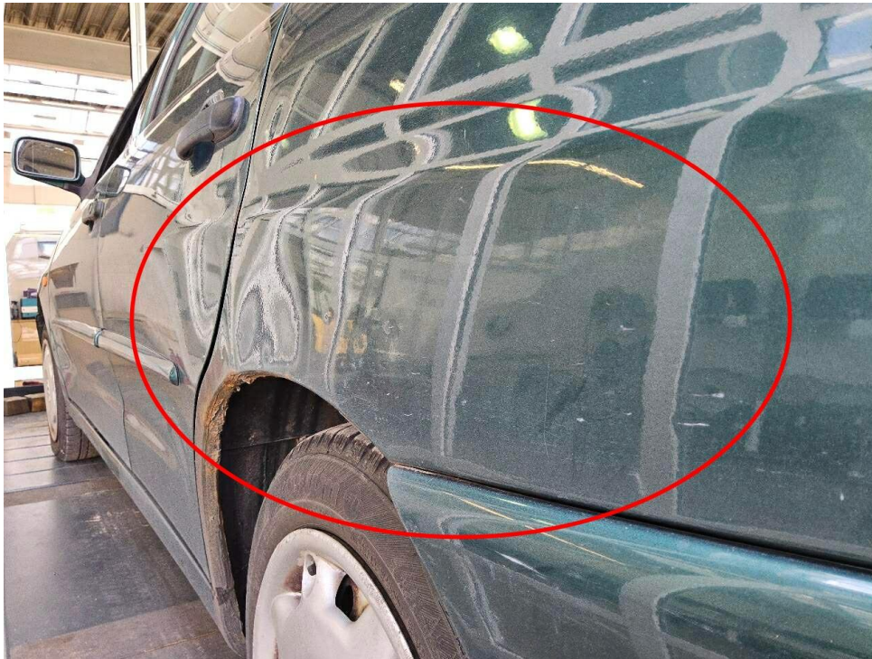
Bild 27 : Fahrzeug rundum zerkratzt und eingedellt
