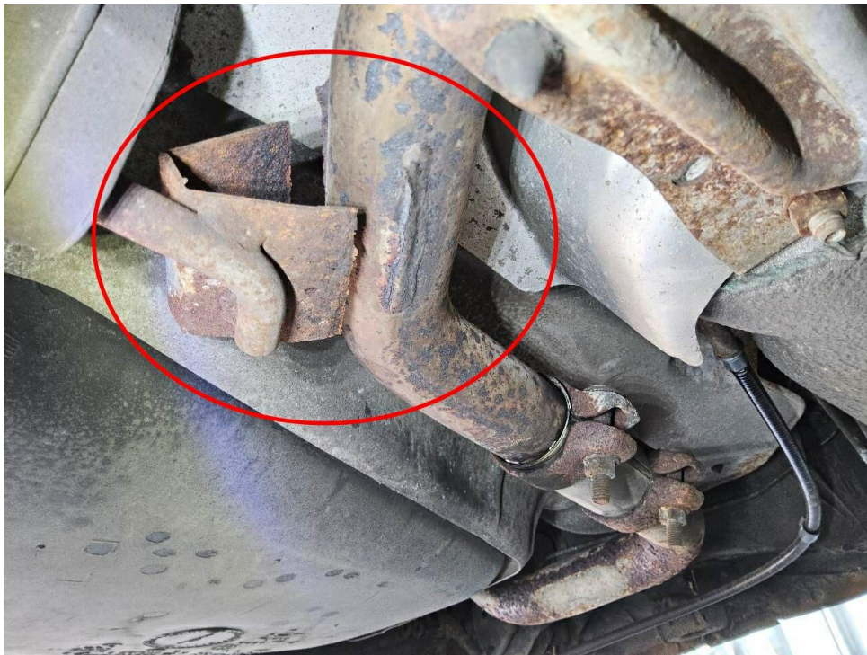
Bild 36 : Auspuff undicht/ Rost
