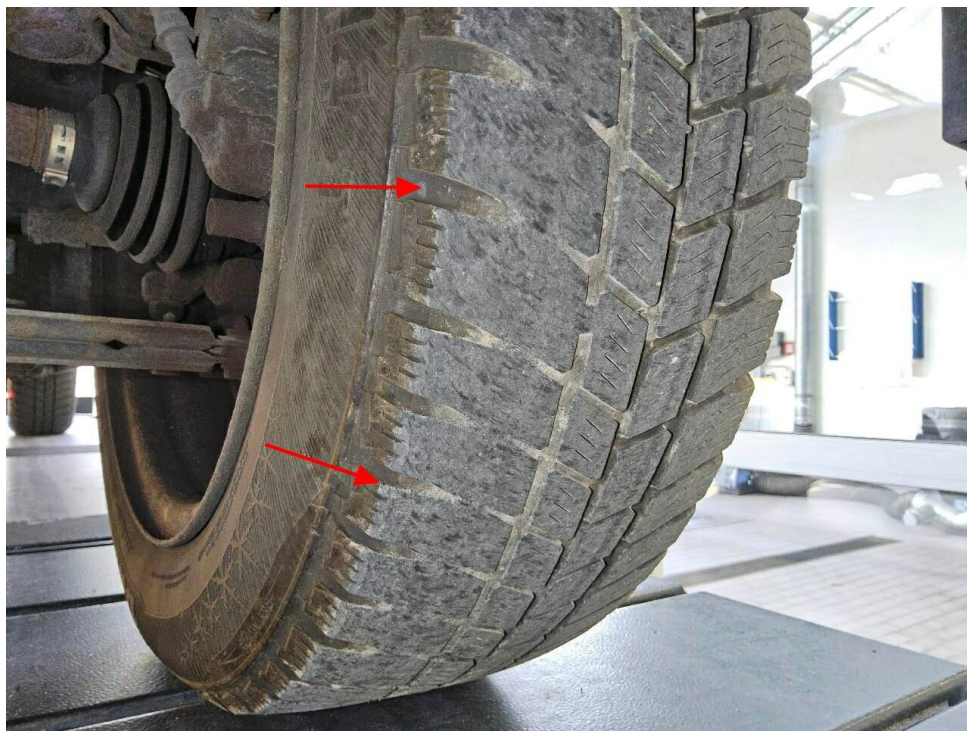
Bild 24 : Reifen einseitig abgefahren
