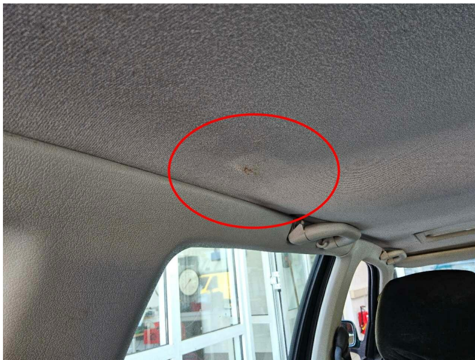
Bild 12 : Dachhimmel löst sich
