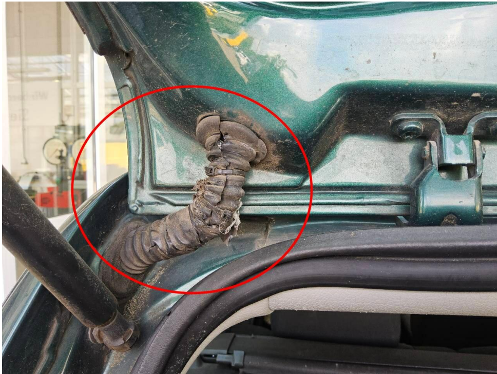
Bild 13 : Heckklappe Verkabelung wurde Instandgesetzt
