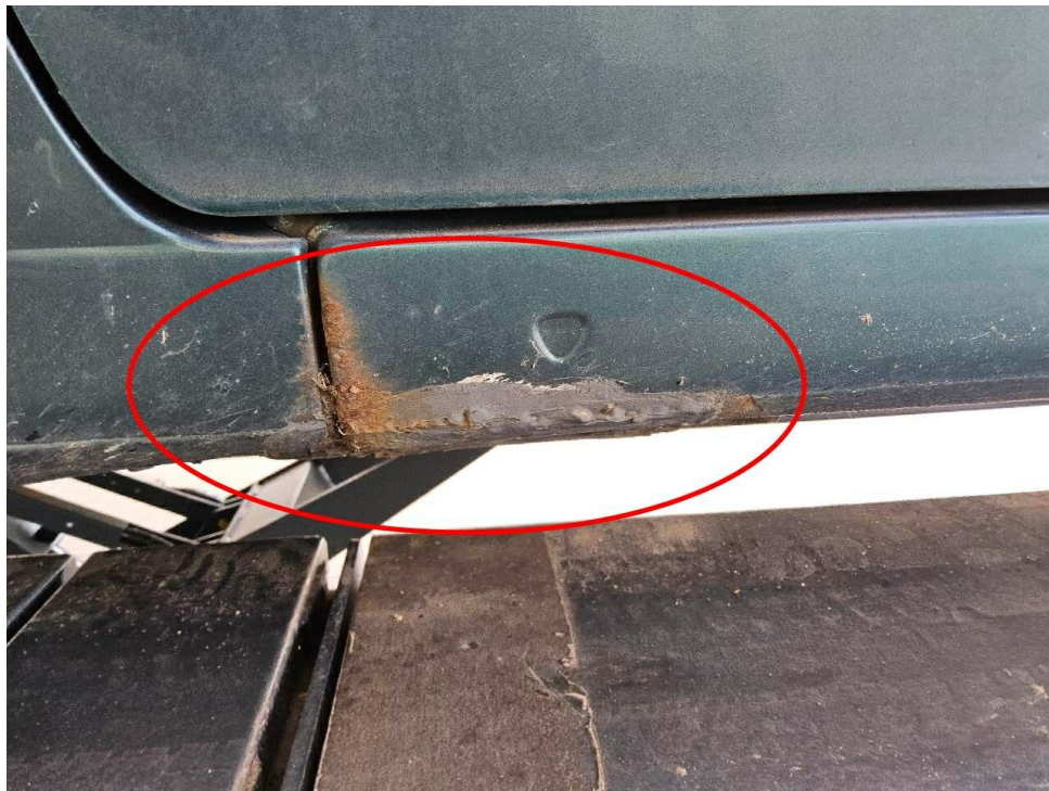
Bild 30 : Schweller links Rostansatz
