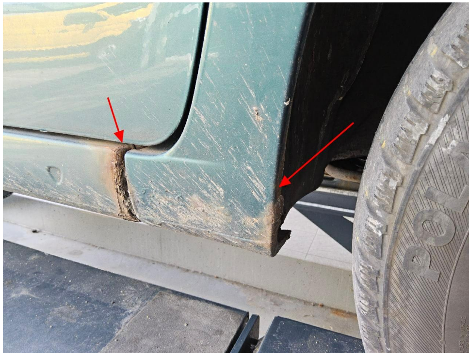
Bild 18 : Kotflügel vorne rechts Rostansatz
