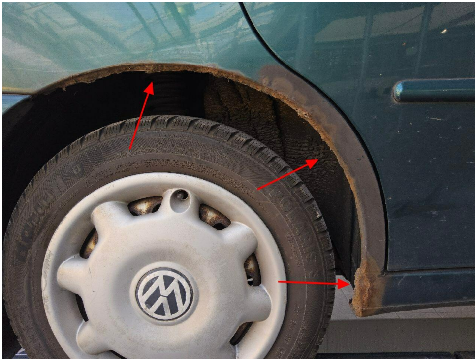
Bild 20 : Seitenwand hinten rechts Rostansatz
