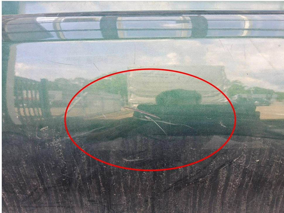
Bild 31 : Stoßfänger hinten verschrammt
