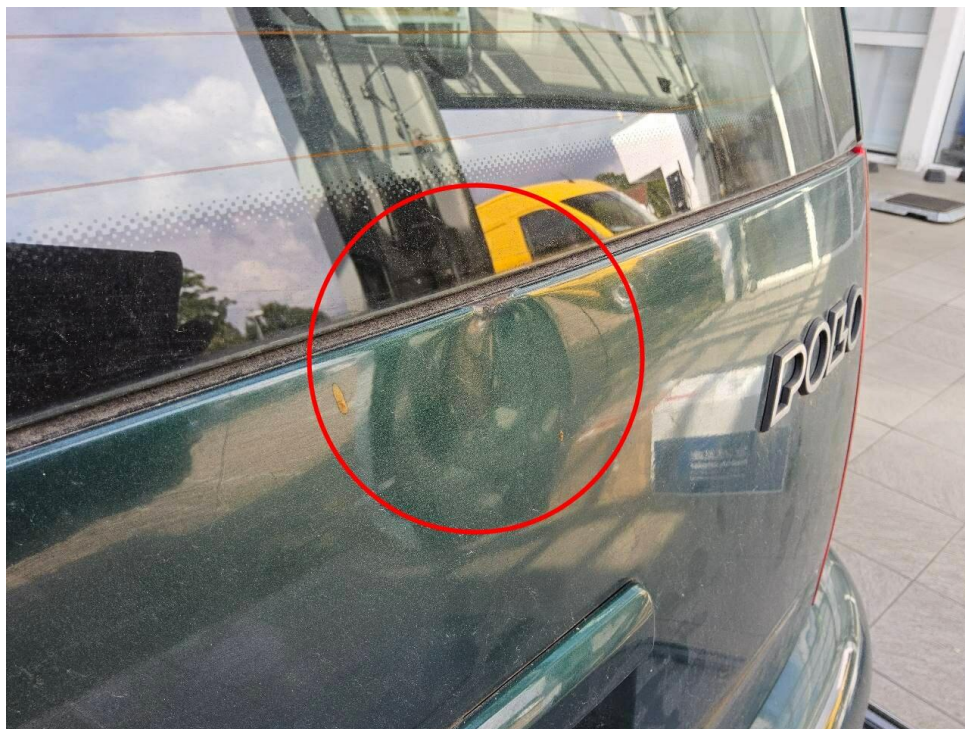
Bild 11 : Heckklappe eingedellt und Rostansatz
