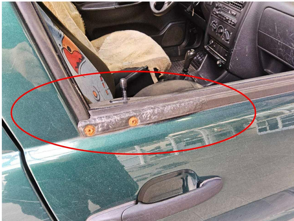
Bild 8 : Tür vorne rechts Schachtleiste Rostansatz
