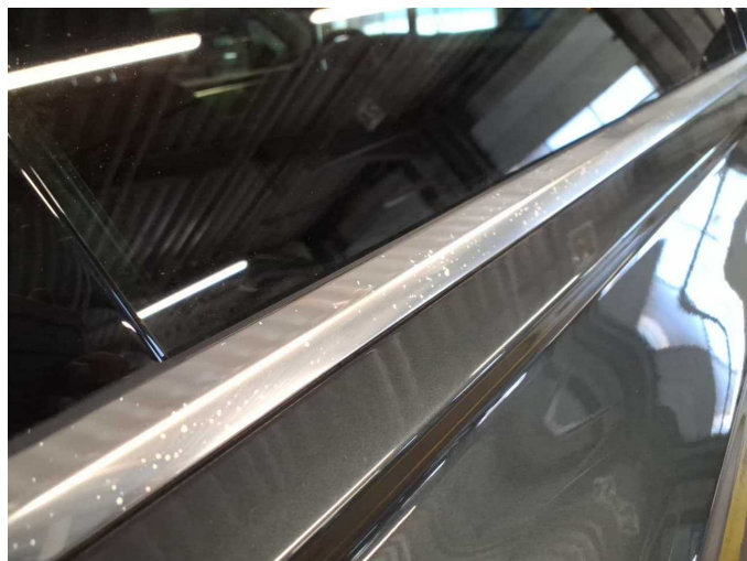
Damage 3: Door - rear right side: Strip - outer (Anätzungen) - Paint defect - Replace
