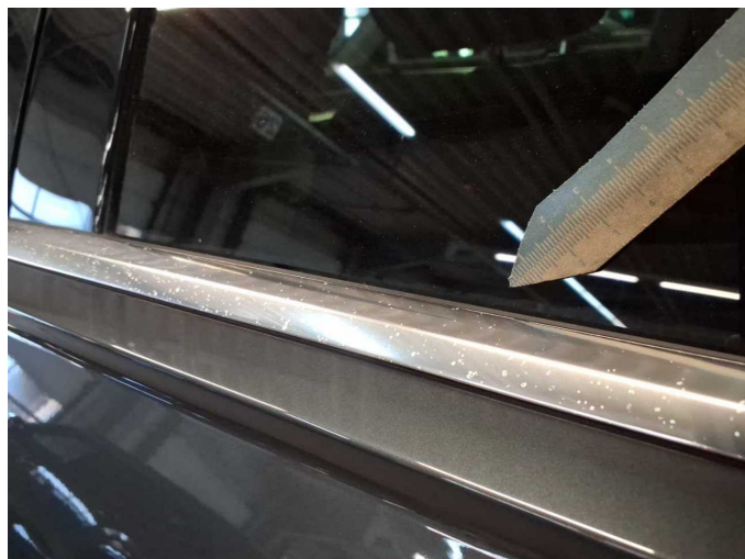
Damage 8: Door - rear left side: Strip - outer (oben und unten, Anätzungen) - Paint defect - Replace
