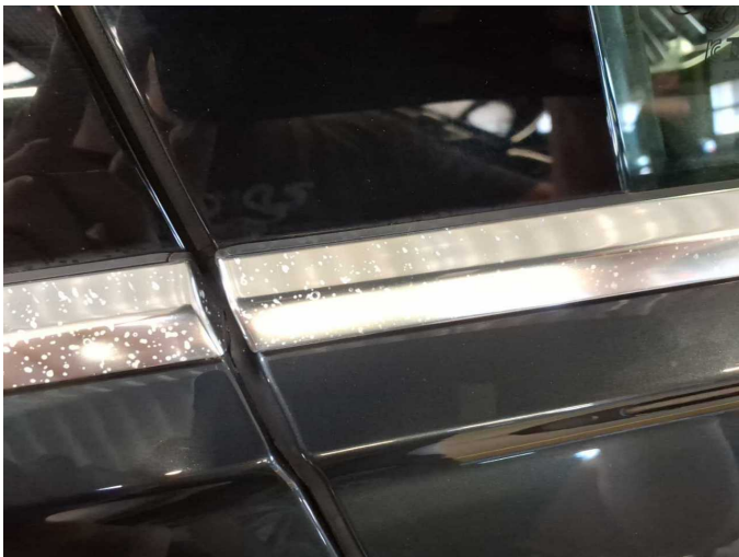
Damage 10: Door - front right side: Strip - outer (oben und unten, Anätzungen) - Paint defect - Replace
