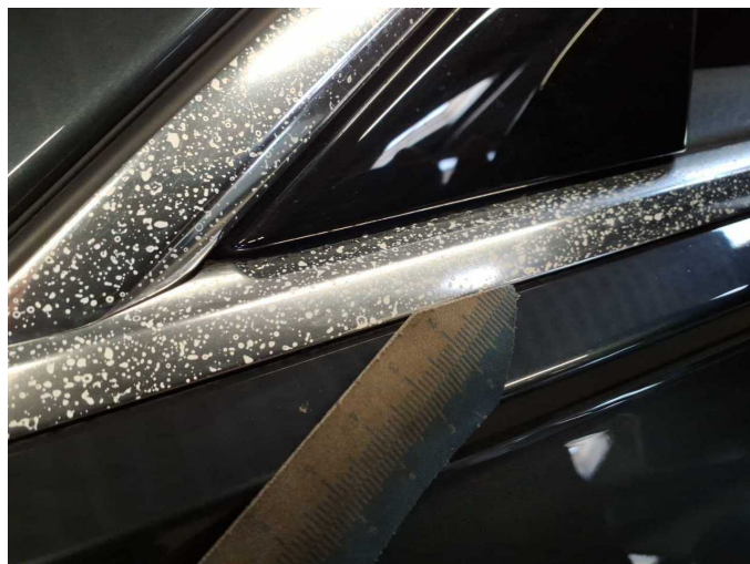
Damage 11: Door - front left side: Strip - outer (oben und unten, Anätzungen) - Paint defect - Replace
