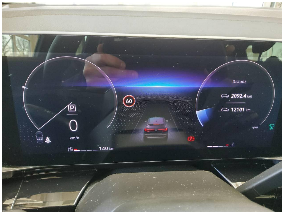
Bild 6 : Kombiinstrument (betriebsbereit) mit Kilometerstand
