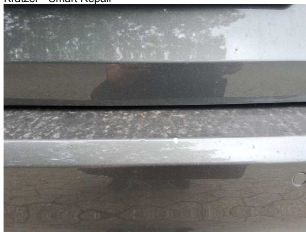
Beschädigung #4: Stossfänger hinten: Stossfänger hinten - Kratzer - lackieren
