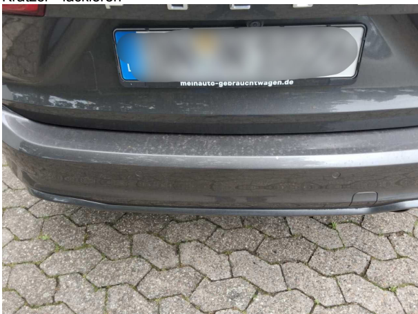
Beschädigung #4: Stossfänger hinten: Stossfänger hinten - Kratzer - lackieren
