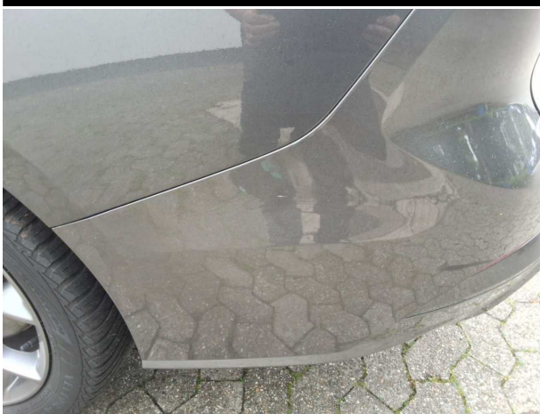
Beschädigung #4: Stossfänger hinten: Stossfänger hinten - Kratzer - lackieren
