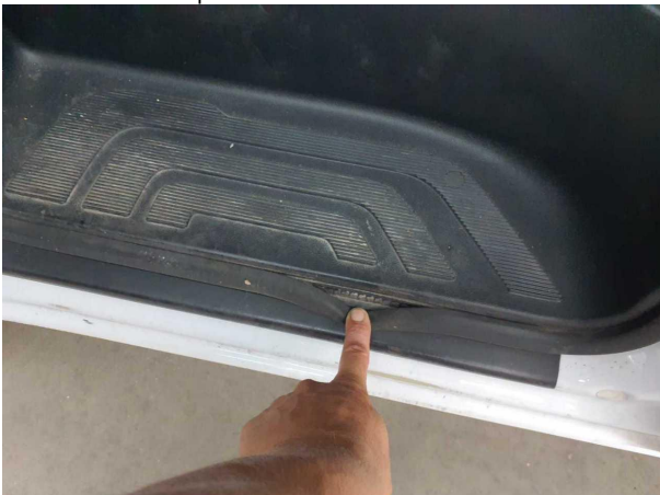
Beschädigung #4: Tür vorn links: Türdichtung - beschädigt - erneuern
