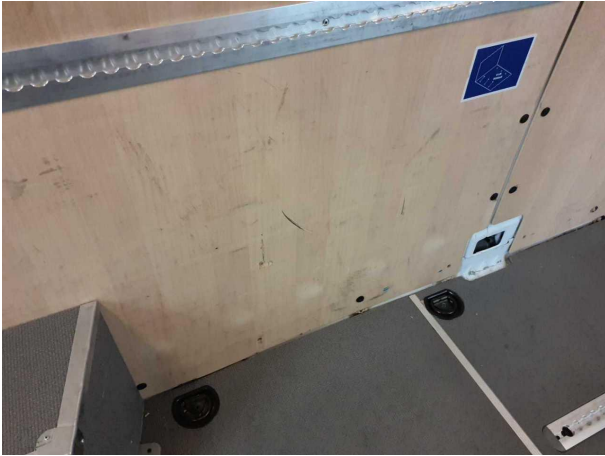
Beschädigung #18: Verkleidungen/Abdeckungen: Laderaumverkleidung links - gebrochen / gerissen - erneuern
