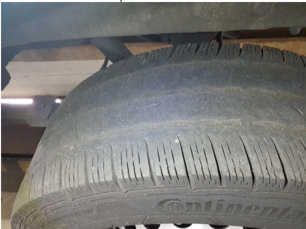
Beschädigung #17: Rad/Reifen: Reifen hinten links - verschlissen - erneuern
