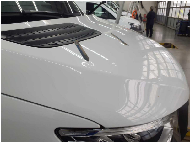
Beschädigung #9: Motorhaube: Motorhaube - Delle(n) - Smart Repair
