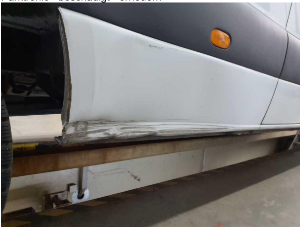
Beschädigung #21: Seitenwand rechts: Seitenwand (v.u.) - beschädi... - erneuern
