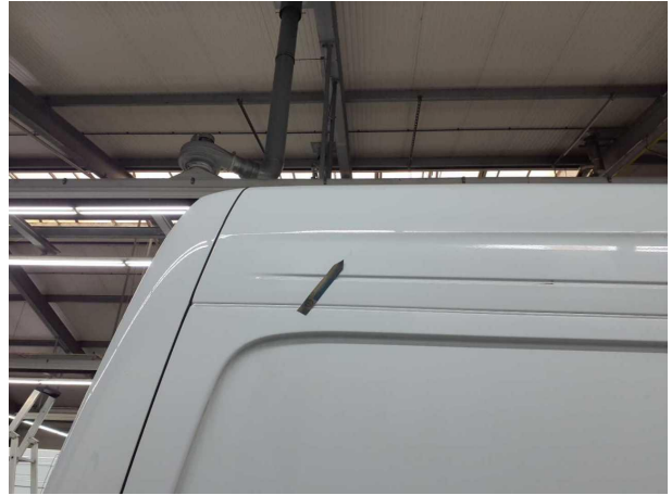
Beschädigung #2: Fahrzeugdach: Dach (Seitenteil hinten rechts) - Kratzer - Smart Repair
