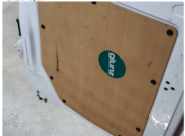
Beschädigung #12: Heckklappe/-tür: Verkl. Hecktür Sperrholz unten - gebrochen / gerissen - erneuern
