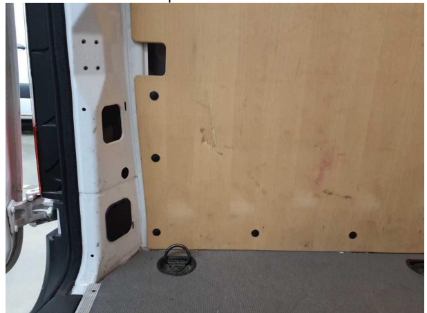
Beschädigung #18: Verkleidungen/Abdeckungen: Laderaumverkleidung links - gebrochen / gerissen - erneuern
