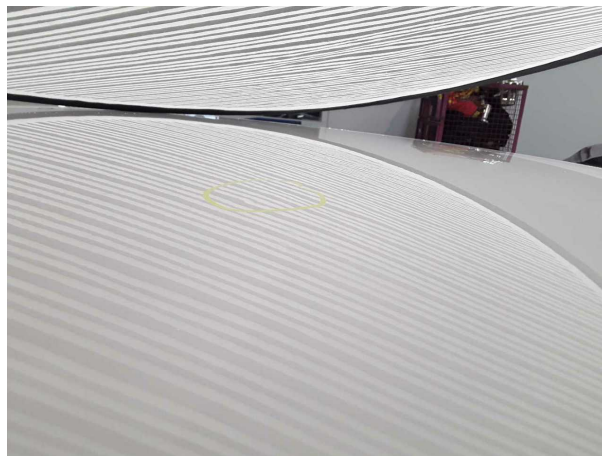
Beschädigung #4: Karosserie: Karosserie - Hagelschaden - instandsetzen
