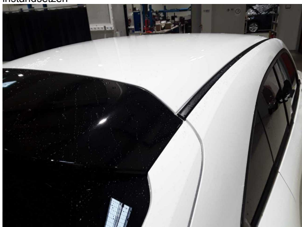
Beschädigung #4: Karosserie: Karosserie - Hagelschaden - instandsetzen
