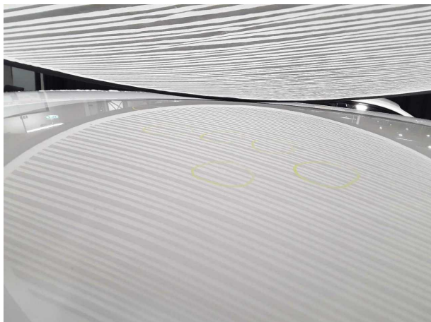
Beschädigung #4: Karosserie: Karosserie - Hagelschaden - instandsetzen
