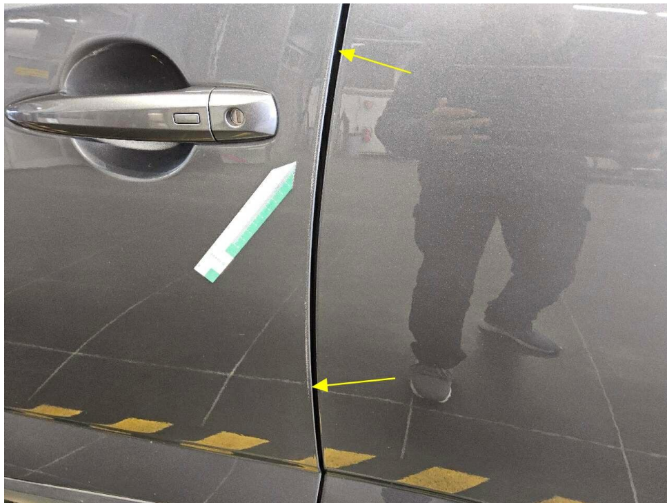
Bild 15 : Ringsum instandgesetzt/nachlackiert außer Dachholm links und rechts, nicht sach- und fachgerecht instandgesetzt/ nachlackiert
