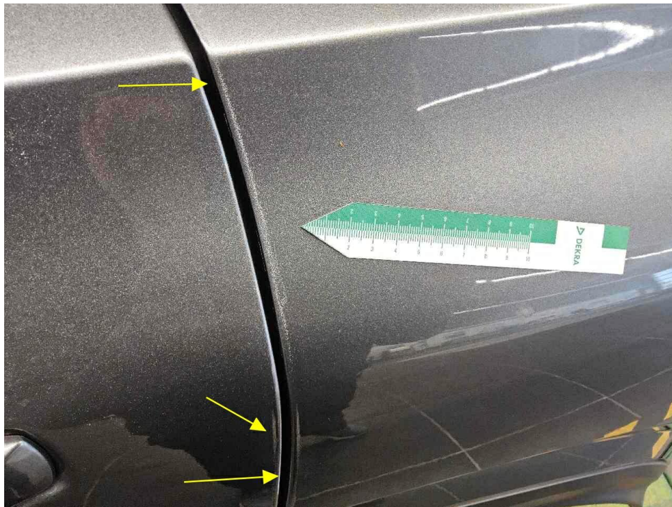
Bild 13 : Ringsum instandgesetzt/nachlackiert außer Dachholm links und rechts, nicht sach- und fachgerecht instandgesetzt/ nachlackiert
