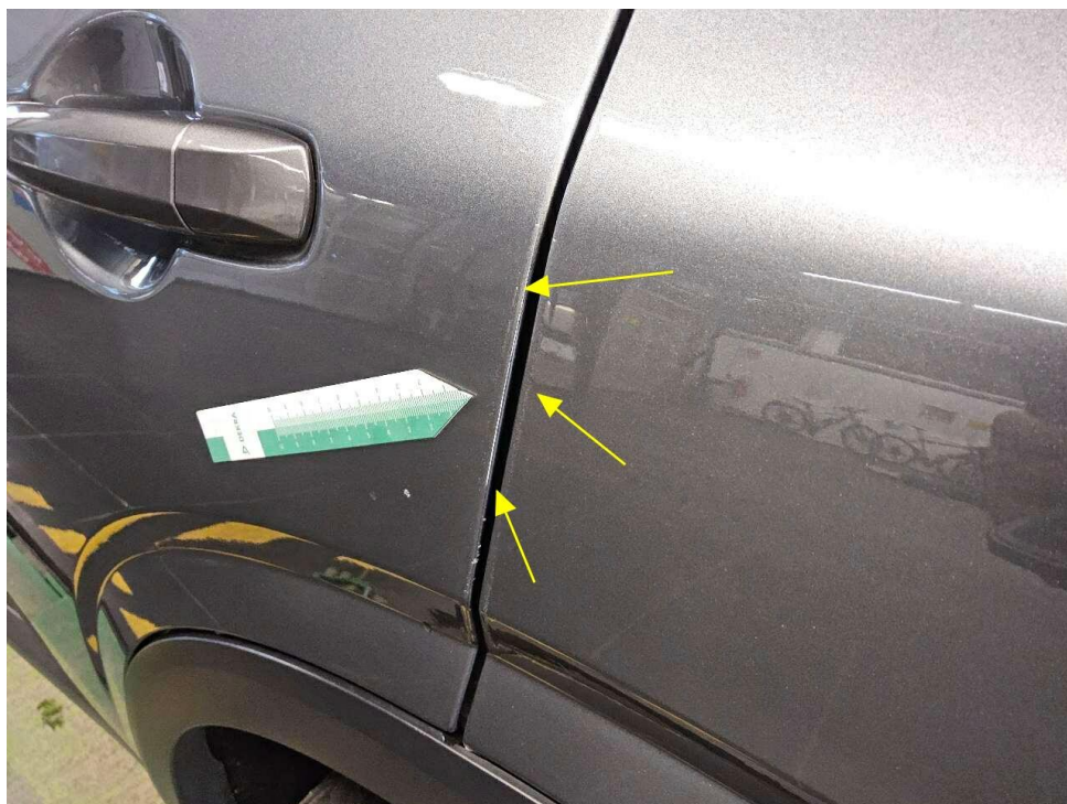
Bild 14 : Ringsum instandgesetzt/nachlackiert außer Dachholm links und rechts, nicht sach- und fachgerecht instandgesetzt/ nachlackiert
