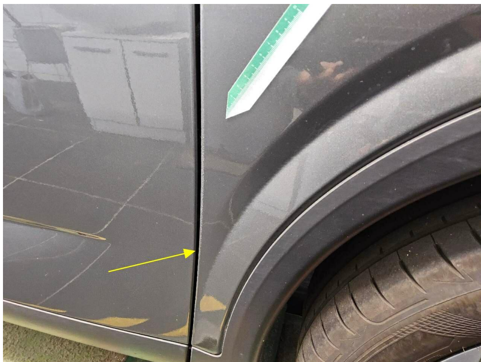
Bild 20 : Ringsum instandgesetzt/nachlackiert außer Dachholm links und rechts, nicht sach- und fachgerecht instandgesetzt/ nachlackiert
