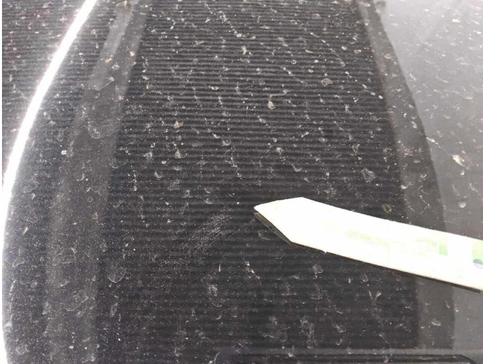
Bild 21 : Motorhaube Lackierung, Steinschlag, Gebrauchsspur
