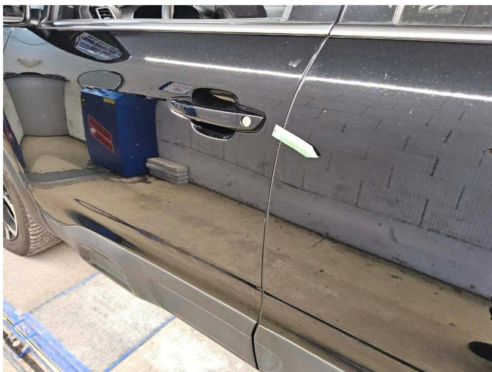
Bild 16 : Tür hinten links Lackierung, zerkratzt, Gebrauchsspur
