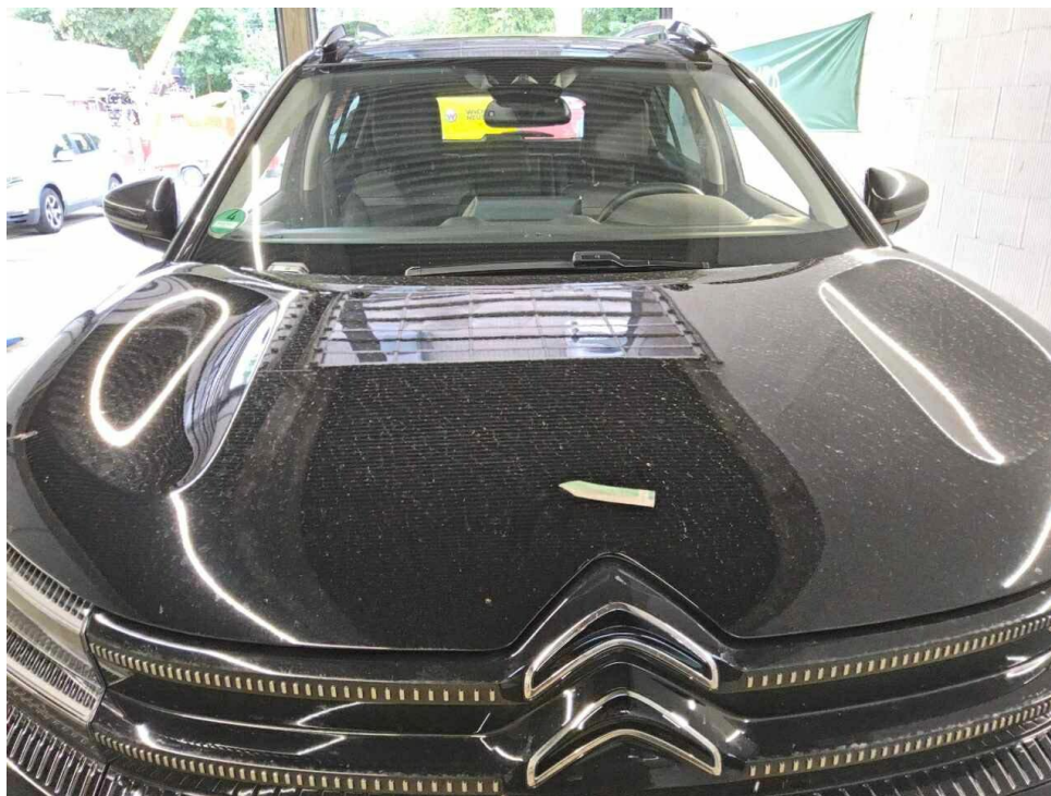
Bild 20 : Motorhaube Lackierung, Steinschlag, Gebrauchsspur
