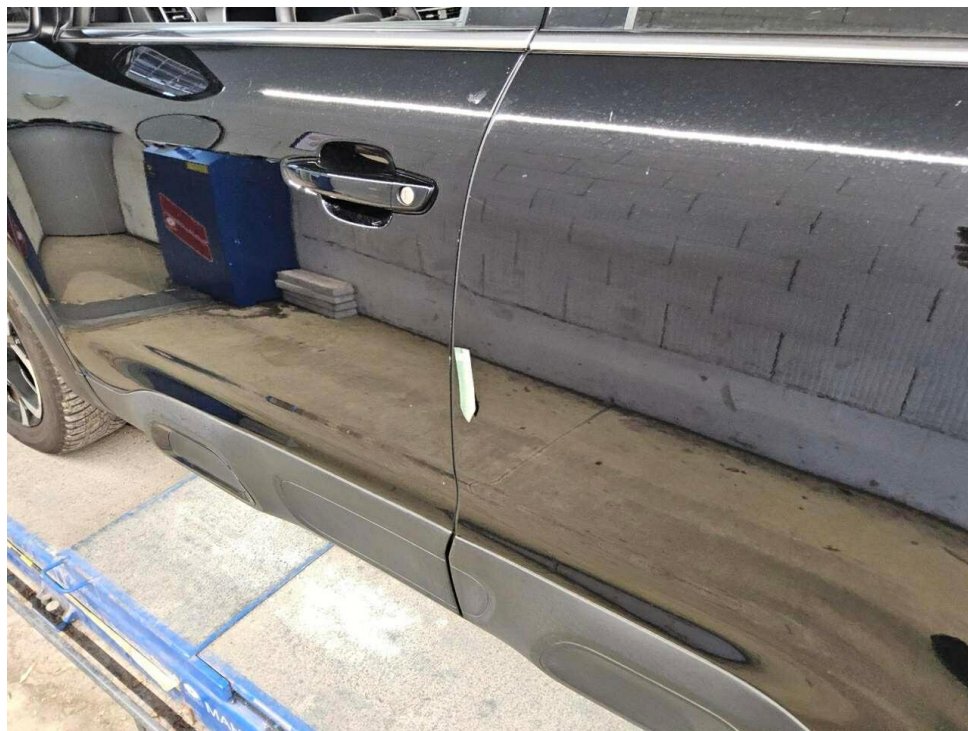
Bild 14 : Tür vorne links Türkante, zerkratzt, Gebrauchsspur
