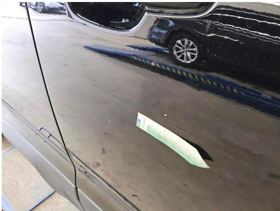
Bild 19 : Tür vorne rechts Lackierung, zerkratzt, Gebrauchsspur
