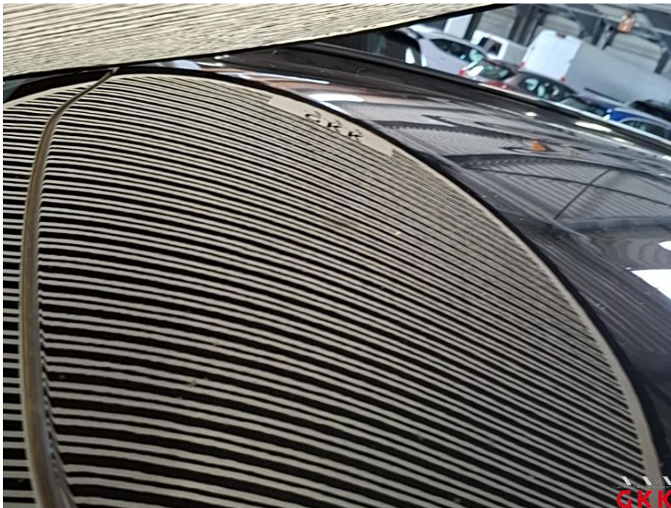
Bild 20 Dach, beschädigt, kalt drücken
