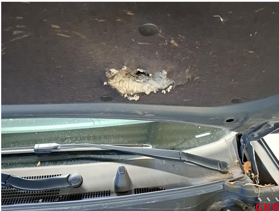
Bild 16 Motorhaube, Dämmmatte, beschädigt, ersetzen
