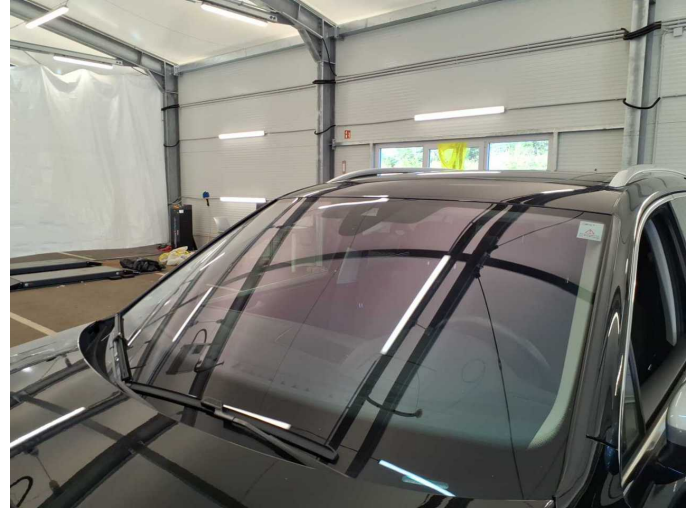
Damage 1: Vehicle glazing: Windscreen (Mit Rissbildung im Fahrersichtfeld) - Stone chips - Replace
