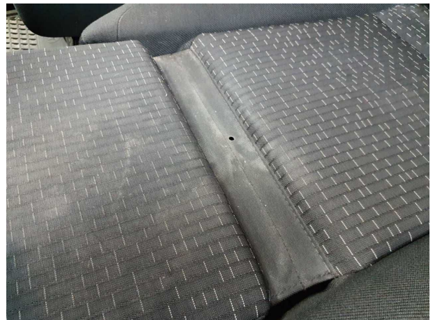
Beschädigung #7: Sitz vorn: Sitzbezug links - Brandloch - erneuern
