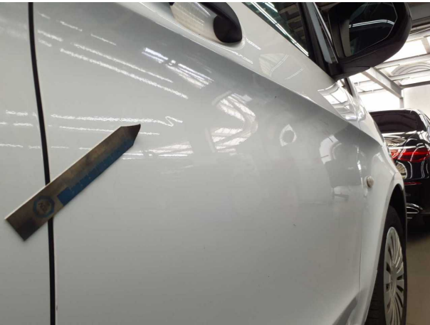
Beschädigung #5: Tür vorn rechts: Tür - Delle(n) - Smart Repair
