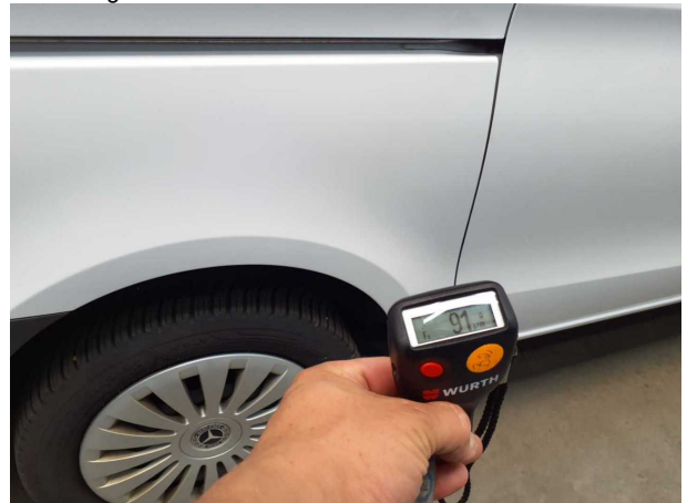
Beschädigung #10: Seitenwand rechts: Kotflügel hinten rechts - Lackmangel - lackieren
