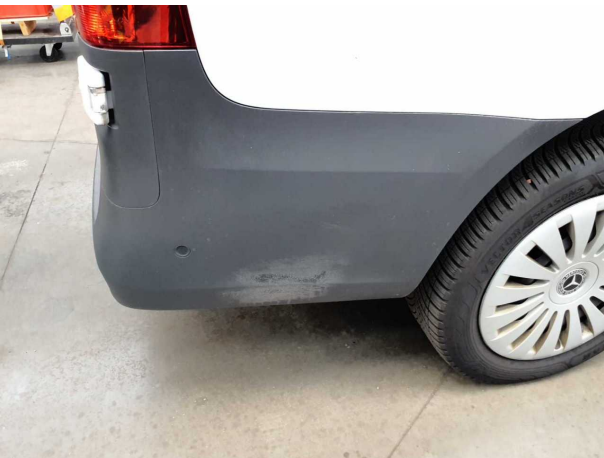
Beschädigung #6: Stossfänger hinten: Stossfänger mit Parktronic - Lackmangel - Smart Repair
