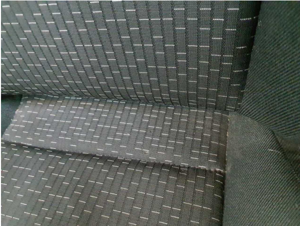
Beschädigung #7: Sitz vorn: Sitzbezug links - Brandloch - erneuern
