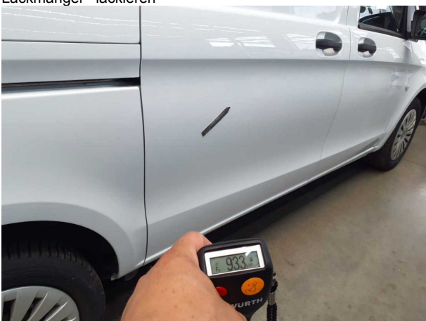
Beschädigung #11: Schiebetür rechts: Schiebetür - nicht fachgerecht instandgesetzt - instandsetzen/lackieren (S1)
