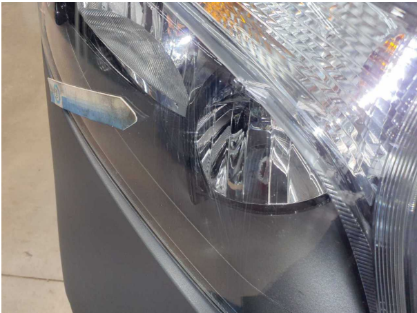
Beschädigung #8: Scheinwerfer: Scheinwerfer rechts - verkratzt / verschürft - erneuern
