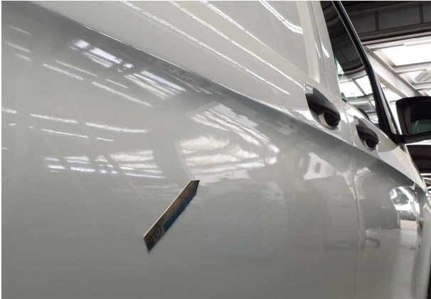
Beschädigung #11: Schiebetür rechts: Schiebetür - nicht fachgerecht instandgesetzt - instandsetzen/lackieren (S1)
