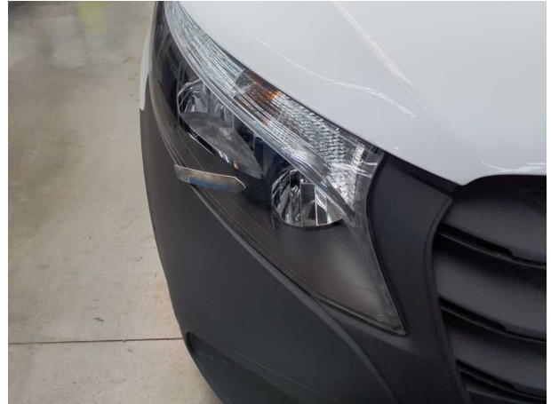
Beschädigung #8: Scheinwerfer: Scheinwerfer rechts - verkratzt / verschürft - erneuern
