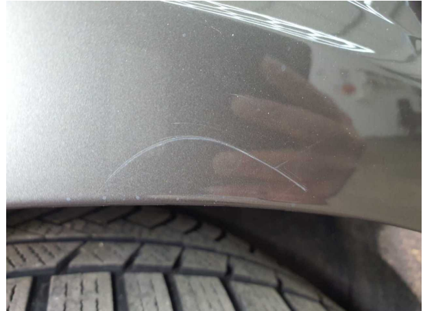
Beschädigung #1: Seitenwand rechts: Seitenwand - Kratzer - auslegen / polieren
