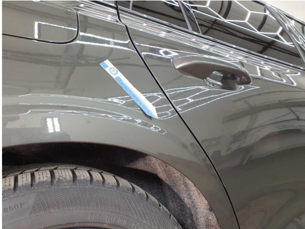
Beschädigung #1: Seitenwand rechts: Seitenwand - Kratzer - auslegen / polieren
