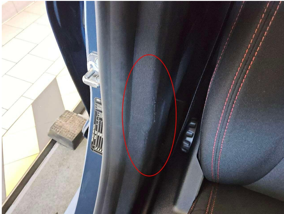
Bild 13 : Verkleidung B-Säule rechts, zerkratzt
