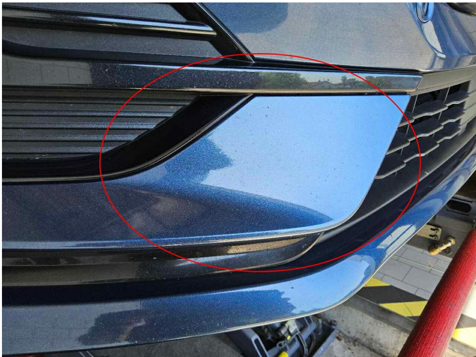
Bild 22 : Stoßfänger vorne, Steinschläge
