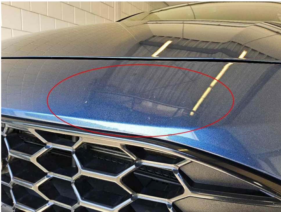
Bild 20 : Stoßfänger vorne, Steinschläge
