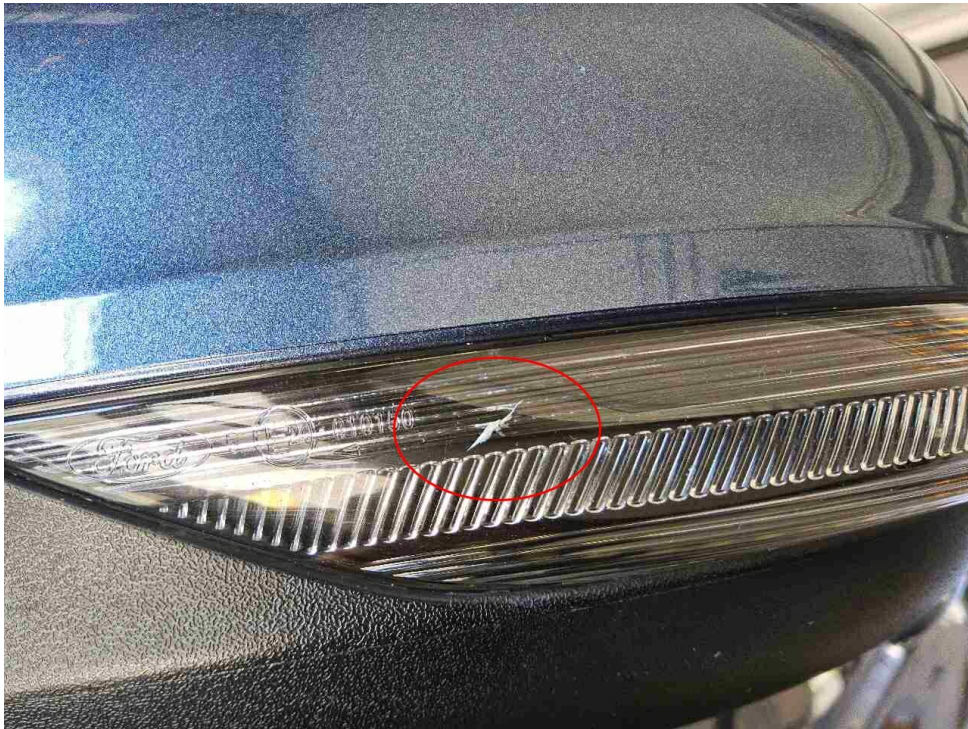
Bild 19 : Außenblinker links, gebrochen
