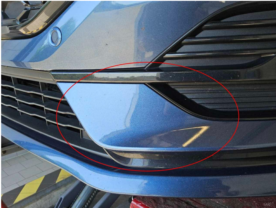
Bild 21 : Stoßfänger vorne, Steinschläge
