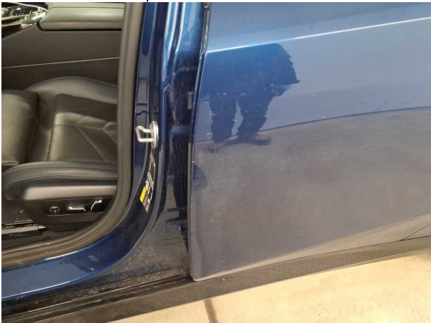
Beschädigung 2: Tür hinten links: Tür - Kratzer - instandsetzen und lackieren
