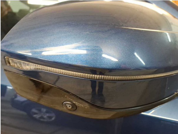
Beschädigung 1: Außenspiegel rechts: Abdeckkappe - verkratzt / verschürft - Smart Repair
