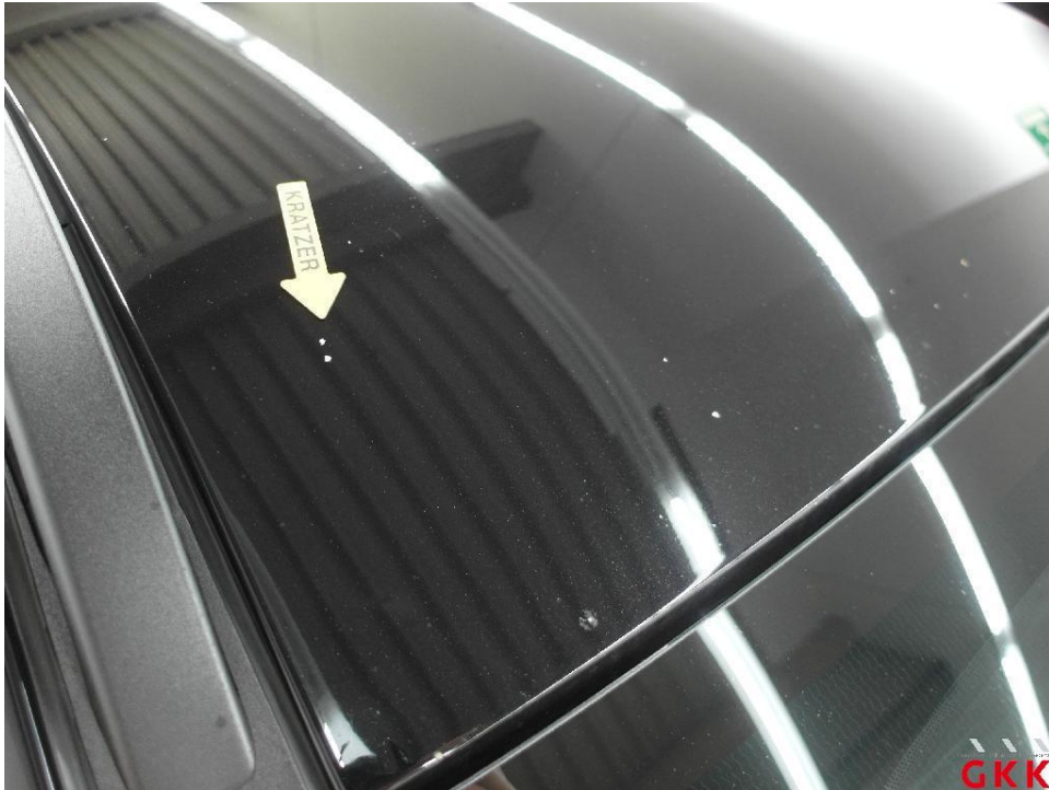
Bild 19. Dach, vorne, Steinschlag und Kratzer, auslegen, schleifen, polieren
