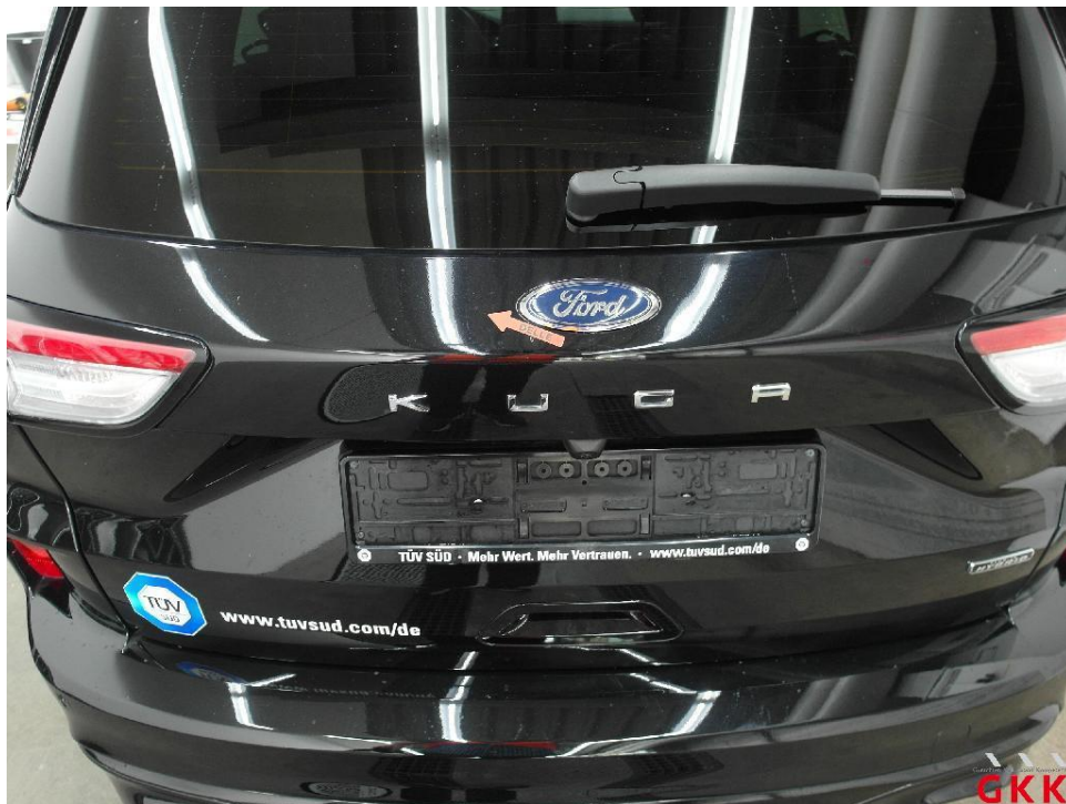
Bild 24. Heckklappe, bis 3 Dellen / Bauteil, kalt drücken
