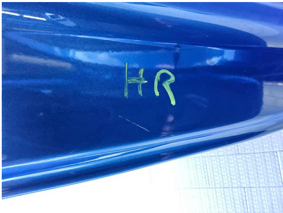
Bild 13 : Tür hinten rechts Einstieg Lackierung, zerkratzt, Gebrauchsspur
