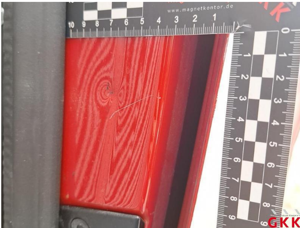
Bild 32. B- Säule rechts, beschädigt, instand setzen - lackieren
