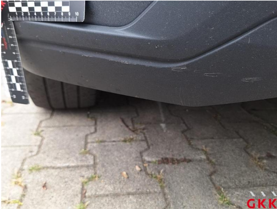
Bild 49. Stoßfänger vorne, Verkleidung -unlackiert-, verkratzt, ersetzen
