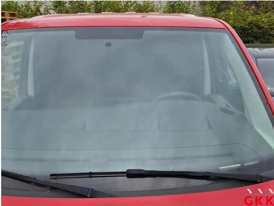
Bild 13. Frontscheibe, Steinschlag im Sichtfeld, ersetzen
