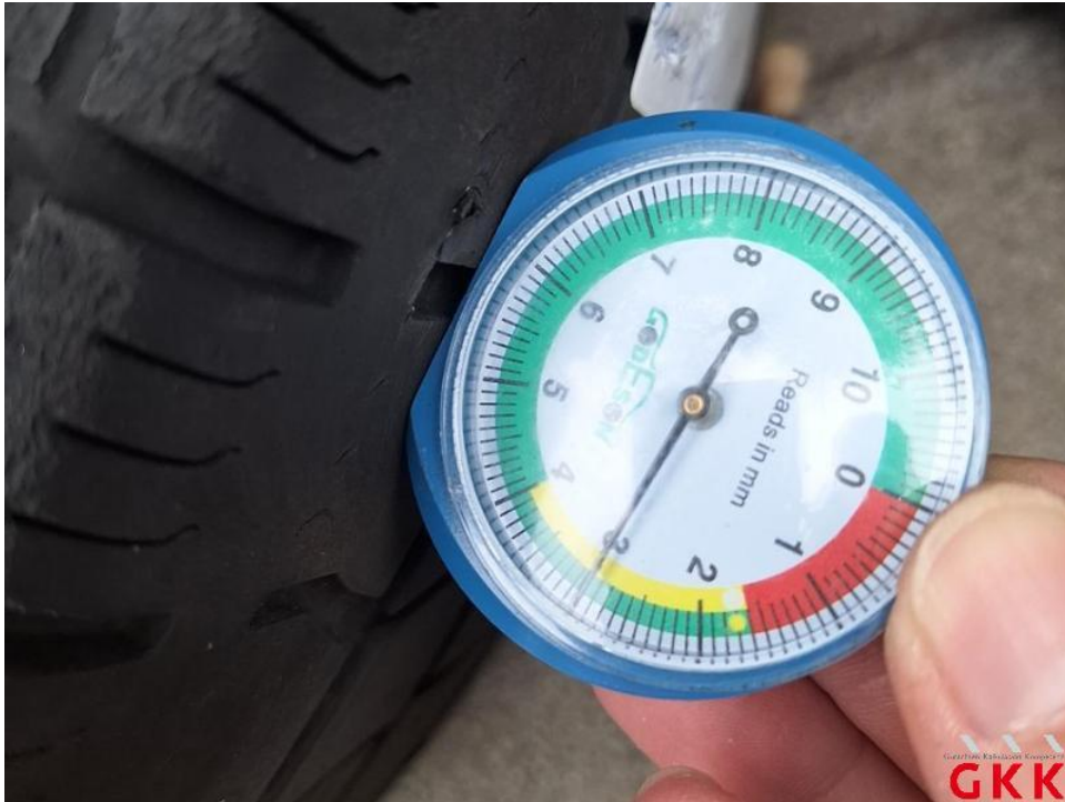
Bild 21. Reifen, 1 x beiliegend, Untermaß, ersetzen
