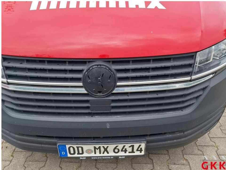
Bild 47. Frontgrill, Emblem, beschädigt, ersetzen
