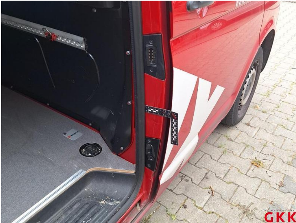
Bild 31. B- Säule rechts, beschädigt, instand setzen - lackieren
