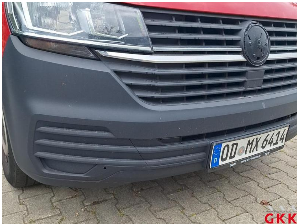
Bild 48. Stoßfänger vorne, Verkleidung -unlackiert-, verkratzt, ersetzen
