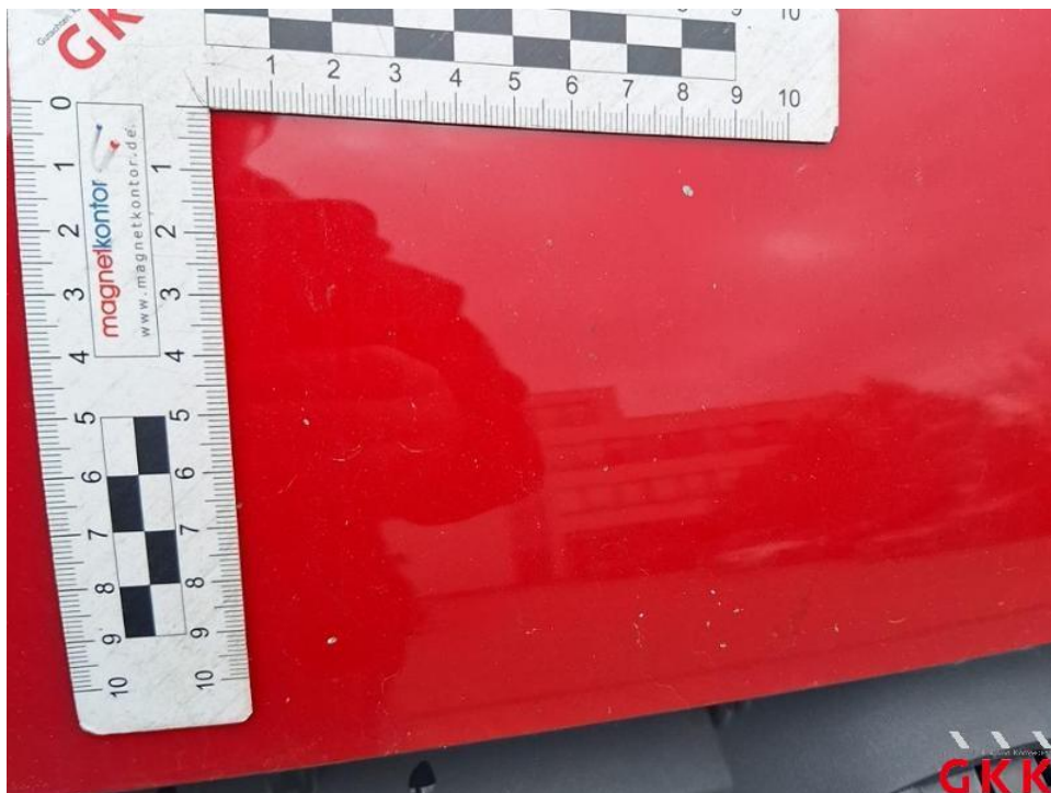
Bild 46. Motorhaube, Steinschlag, lackieren
