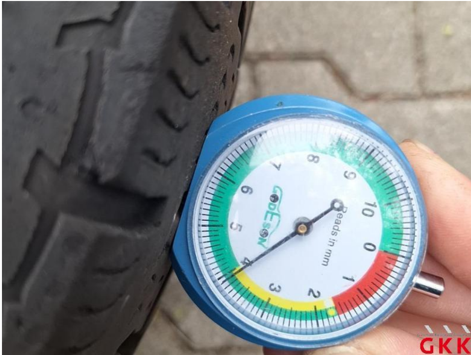
Bild 25. Reifen, 1 x beiliegend, Untermaß, ersetzen
