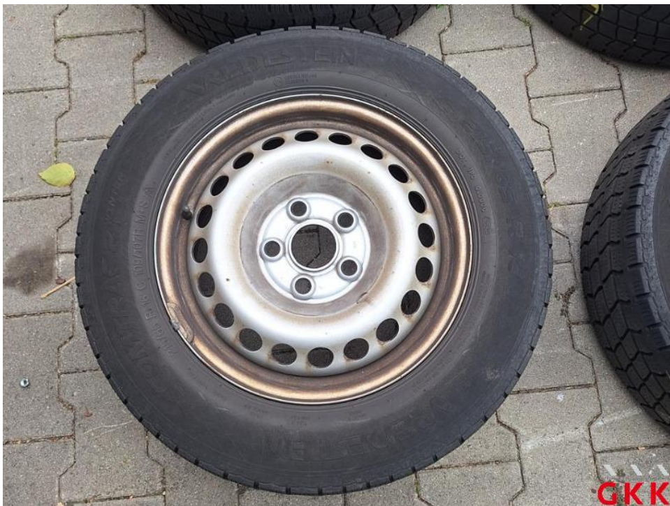
Bild 22. Reifen, 1 x beiliegend, Untermaß, ersetzen
