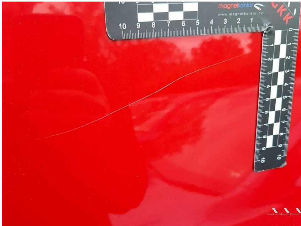
Bild 43. Seitenwand links, verkratzt, polieren
