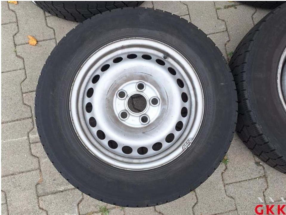
Bild 20. Reifen, 1 x beiliegend, Untermaß, ersetzen
