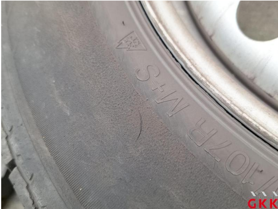
Bild 19. Reifen, 1 x beiliegend, beschädigt und Untermaß, ersetzen
