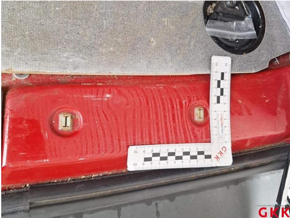
Bild 41. Laderaum-Ladekante, beschädigt, instand setzen
