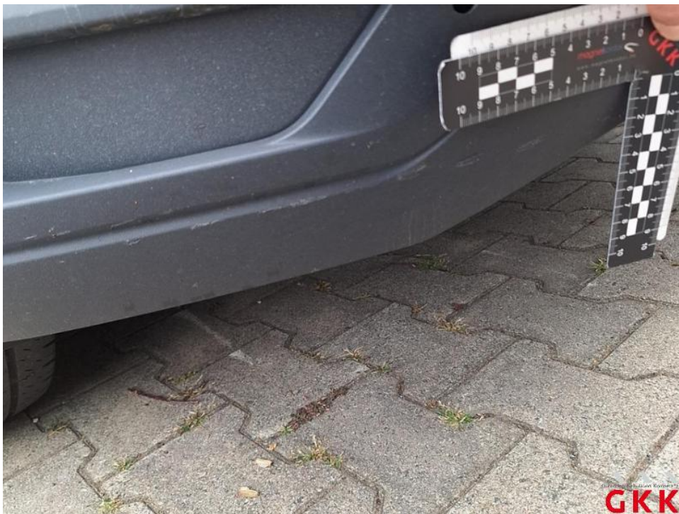
Bild 50. Stoßfänger vorne, Verkleidung -unlackiert-, verkratzt, ersetzen
