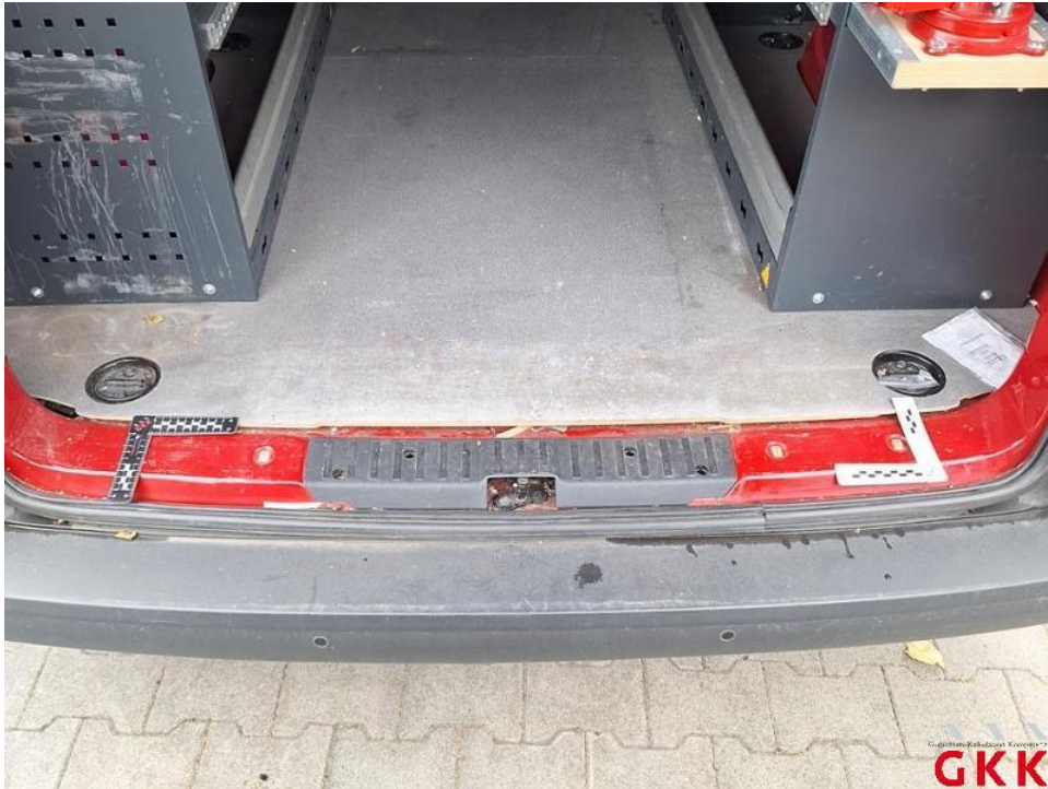
Bild 39. Laderaum-Ladekante, beschädigt, instand setzen
