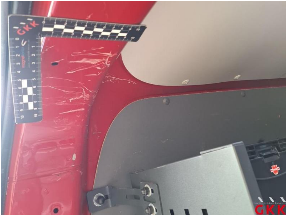
Bild 38. Laderaum, verkratzt, Smartrepair
