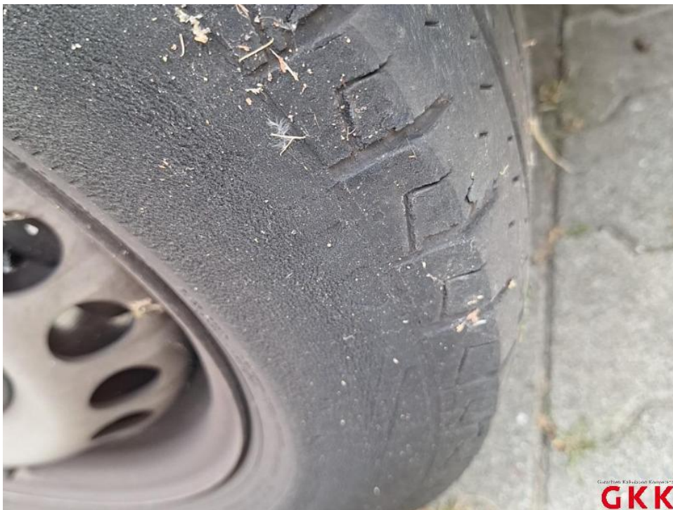
Bild 28. Reifen, vorne rechts, beschädigt, ersetzen
