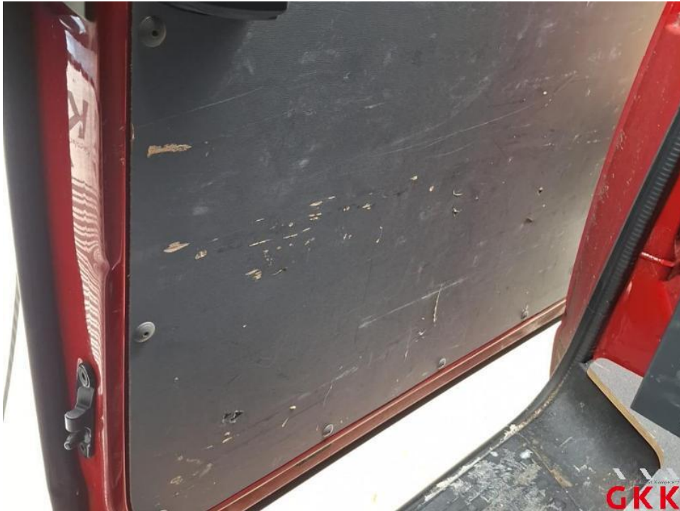
Bild 35. Schiebetür rechts, Innenverkleidung, beschädigt, ersetzen
