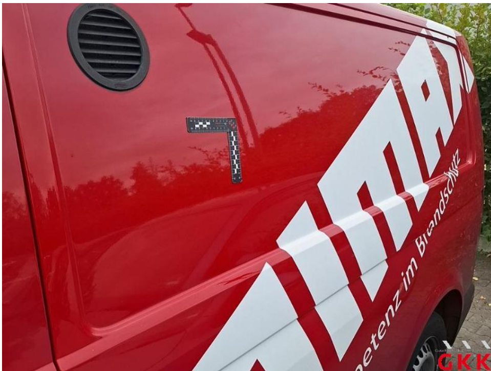
Bild 42. Seitenwand links, verkratzt, polieren
