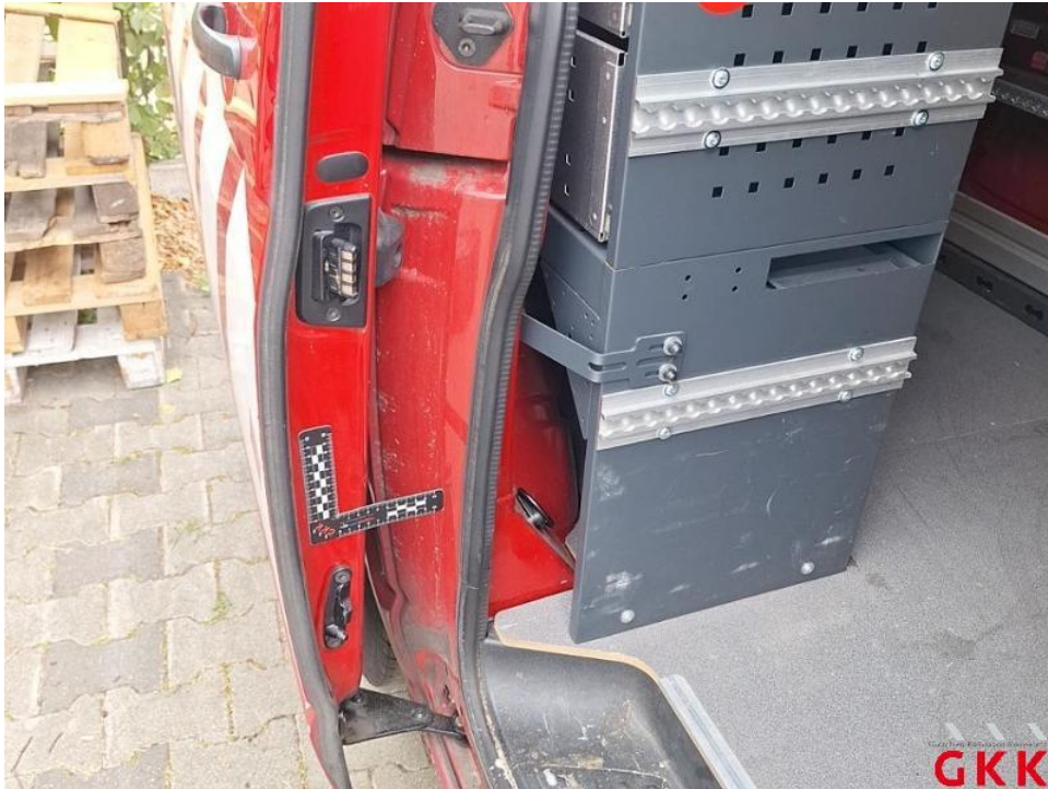
Bild 33. Schiebetür rechts, beschädigt, instand setzen - lackieren
