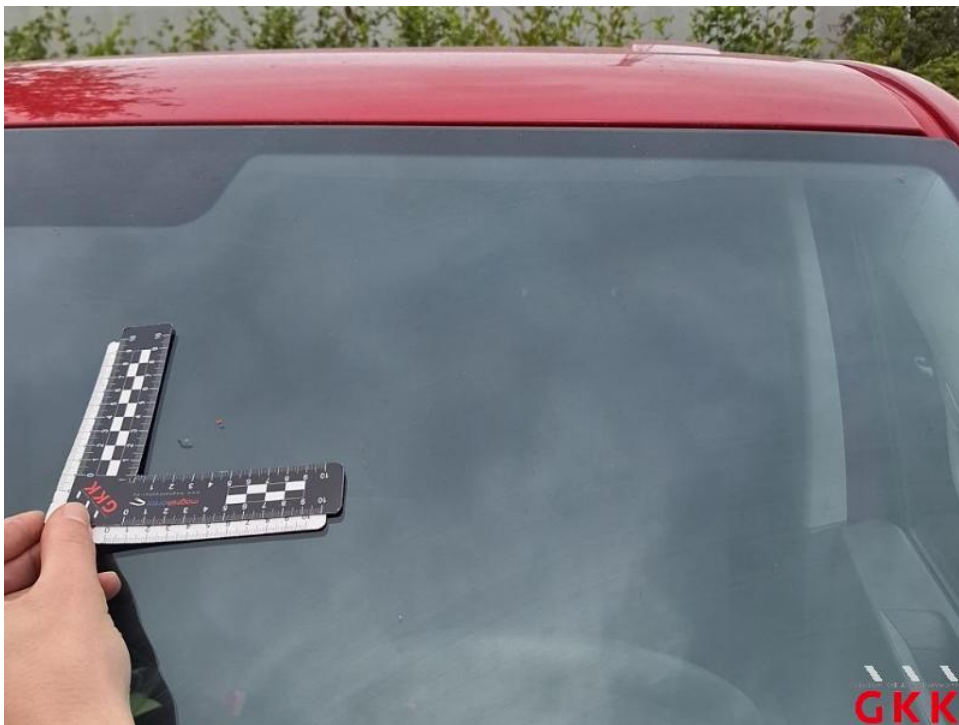
Bild 14. Frontscheibe, Steinschlag im Sichtfeld, ersetzen
