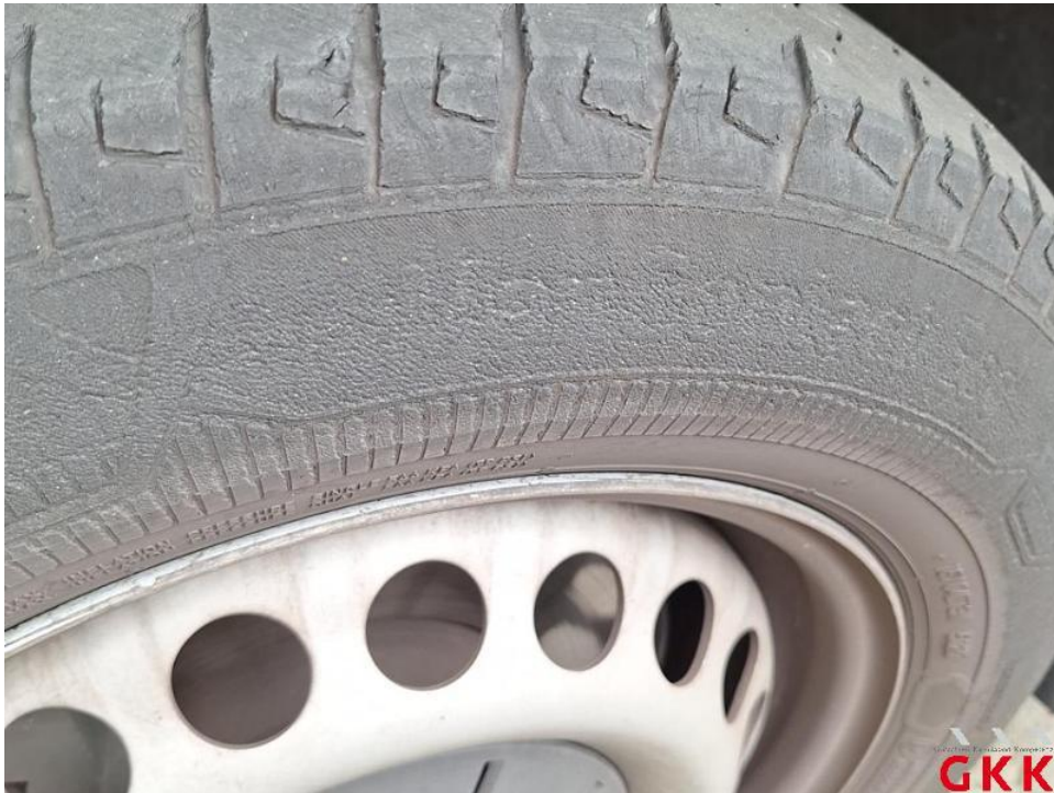
Bild 30. Reifen, vorne links, beschädigt, ersetzen
