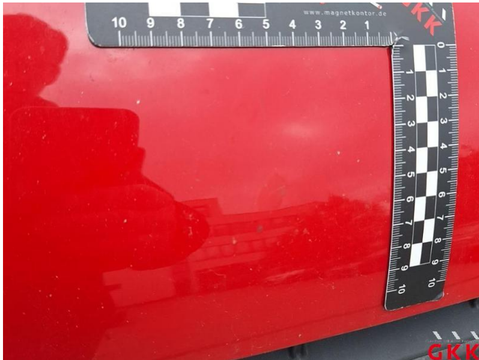
Bild 45. Motorhaube, Steinschlag, lackieren
