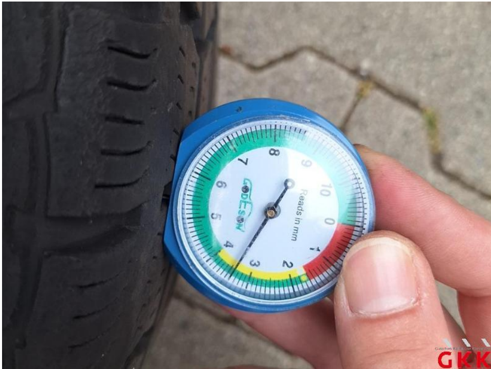
Bild 18. Reifen, 1 x beiliegend, beschädigt und Untermaß, ersetzen
