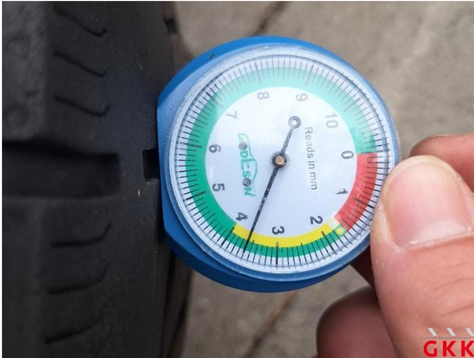
Bild 23. Reifen, 1 x beiliegend, Untermaß, ersetzen
