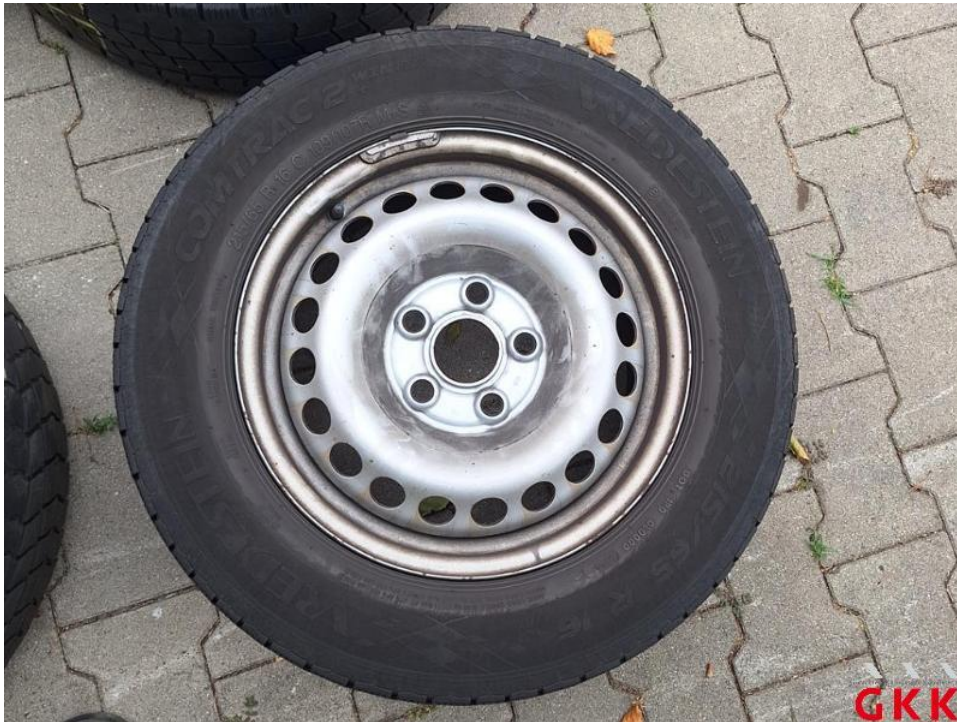
Bild 24. Reifen, 1 x beiliegend, Untermaß, ersetzen
