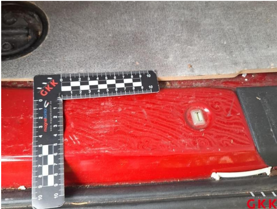
Bild 40. Laderaum-Ladekante, beschädigt, instand setzen
