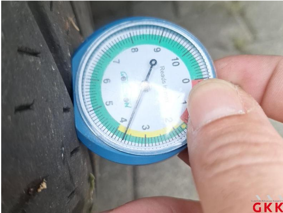
Bild 27. Reifen, vorne rechts, beschädigt, ersetzen
