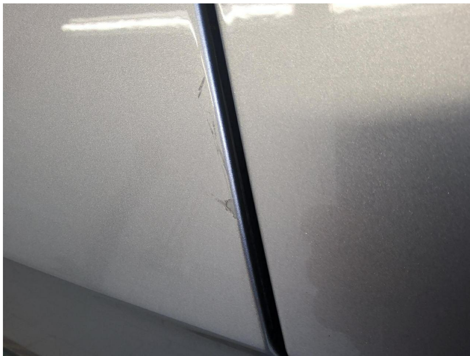
Bild 2 : Seitenteil hinten rechts Lackierung, verschrammt, lackieren
