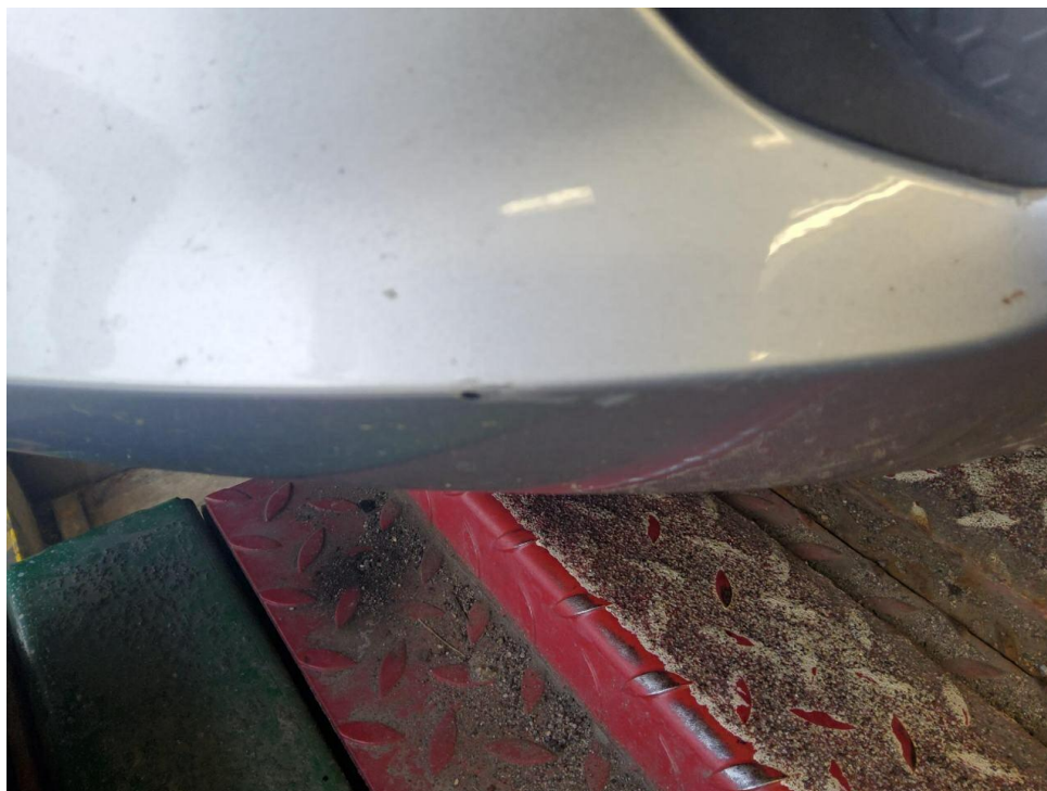
Bild 1 : Stoßfänger vorne Lackierung, viele Steinschläge, smart repair
