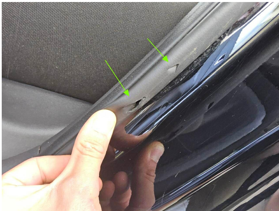
Bild 7 : Tür hinten links, Dichtgummi gerissen
