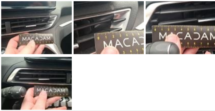
Garn montant AVG, Dégrafé, Dépose/Repose
