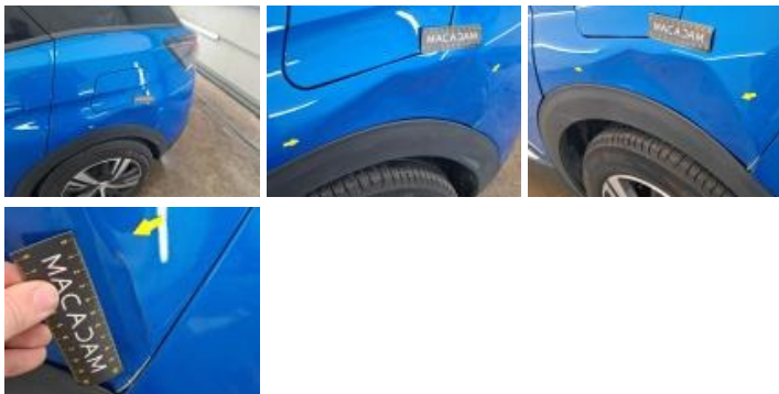
Moulure porte ARG, Déformé / Forcé, E - Remplacer
