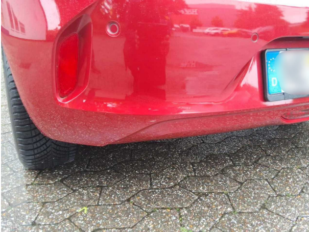
Beschädigung #1: Stossfänger hinten: Stossfänger hinten - Kratzer - lackieren
