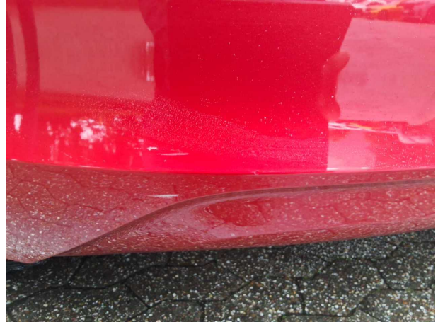
Beschädigung #1: Stossfänger hinten: Stossfänger hinten - Kratzer - lackieren
