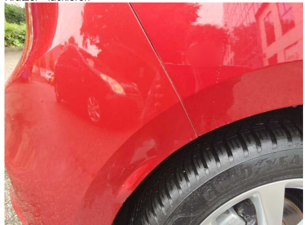
Beschädigung #1: Stossfänger hinten: Stossfänger hinten - Kratzer - lackieren
