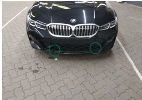
Stoßfängergrill / Vorne / Gebrochen
