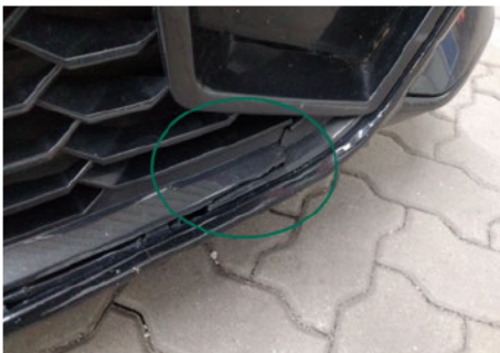
Stoßfängergrill / Vorne / Gebrochen
