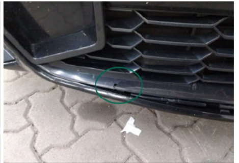
Stoßfängergrill / Vorne / Gebrochen
