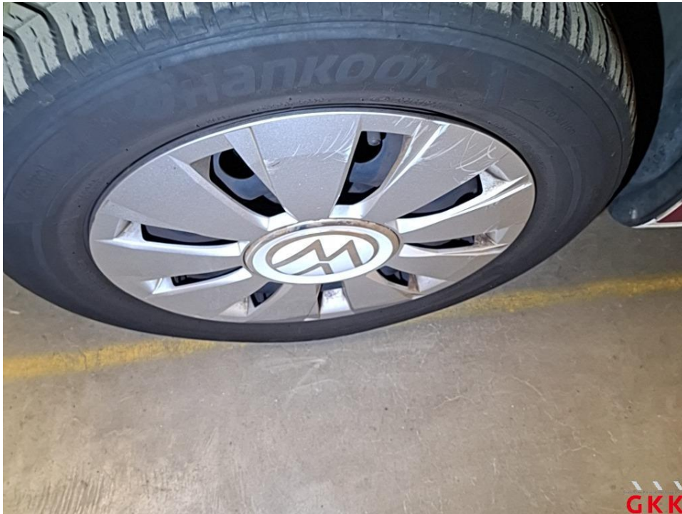
Bild 15 Radkappe(n), Satz, beschädigt, ersetzen
