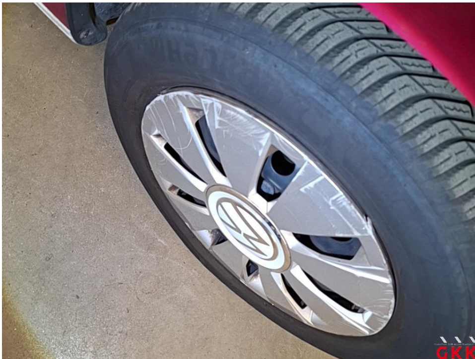
Bild 16 Radkappe(n), Satz, beschädigt, ersetzen
