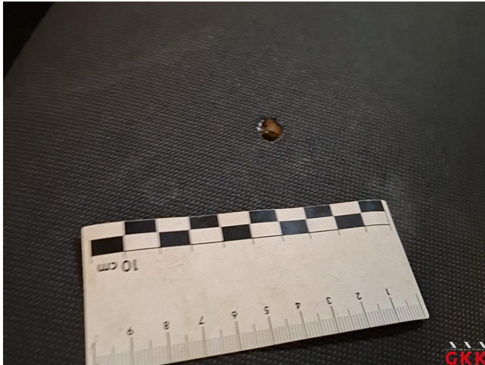
Bild 23 Sitz vorne links, Bezug Rückenlehne -Stoff-, Brandloch, ersetzen
