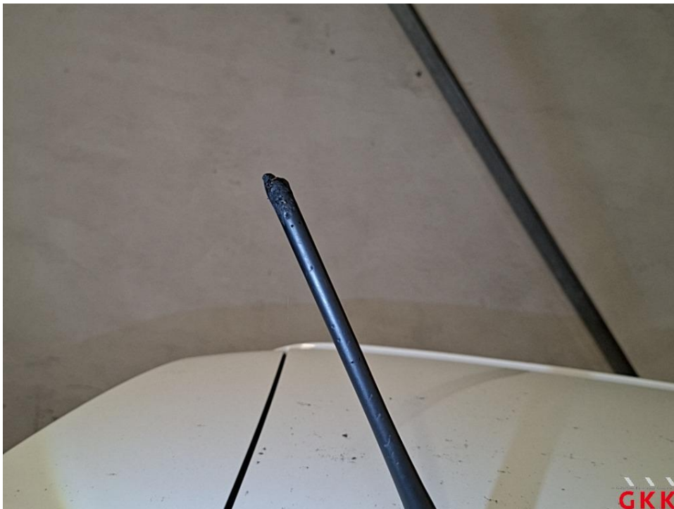
Bild 18 Antenne, Stab, beschädigt, ersetzen
