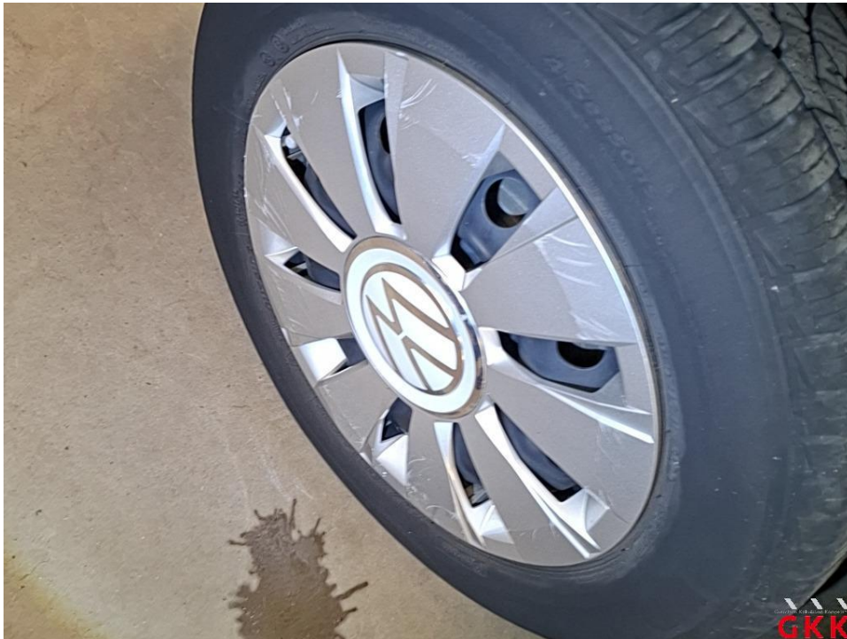
Bild 17 Radkappe(n), Satz, beschädigt, ersetzen
