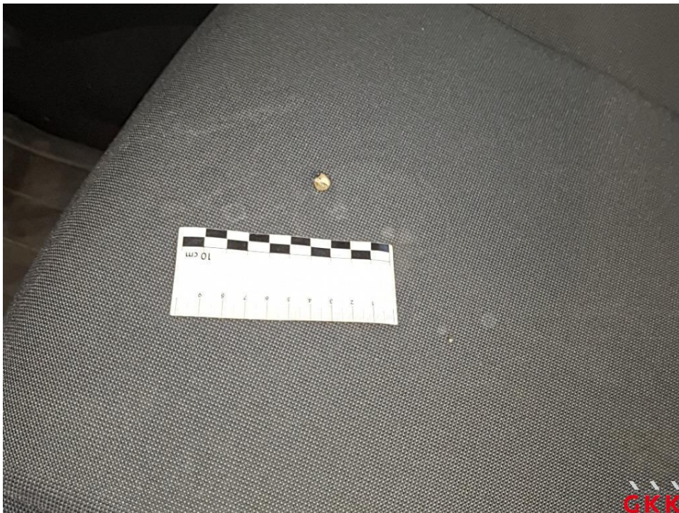
Bild 22 Sitz vorne links, Bezug Rückenlehne -Stoff-, Brandloch, ersetzen
