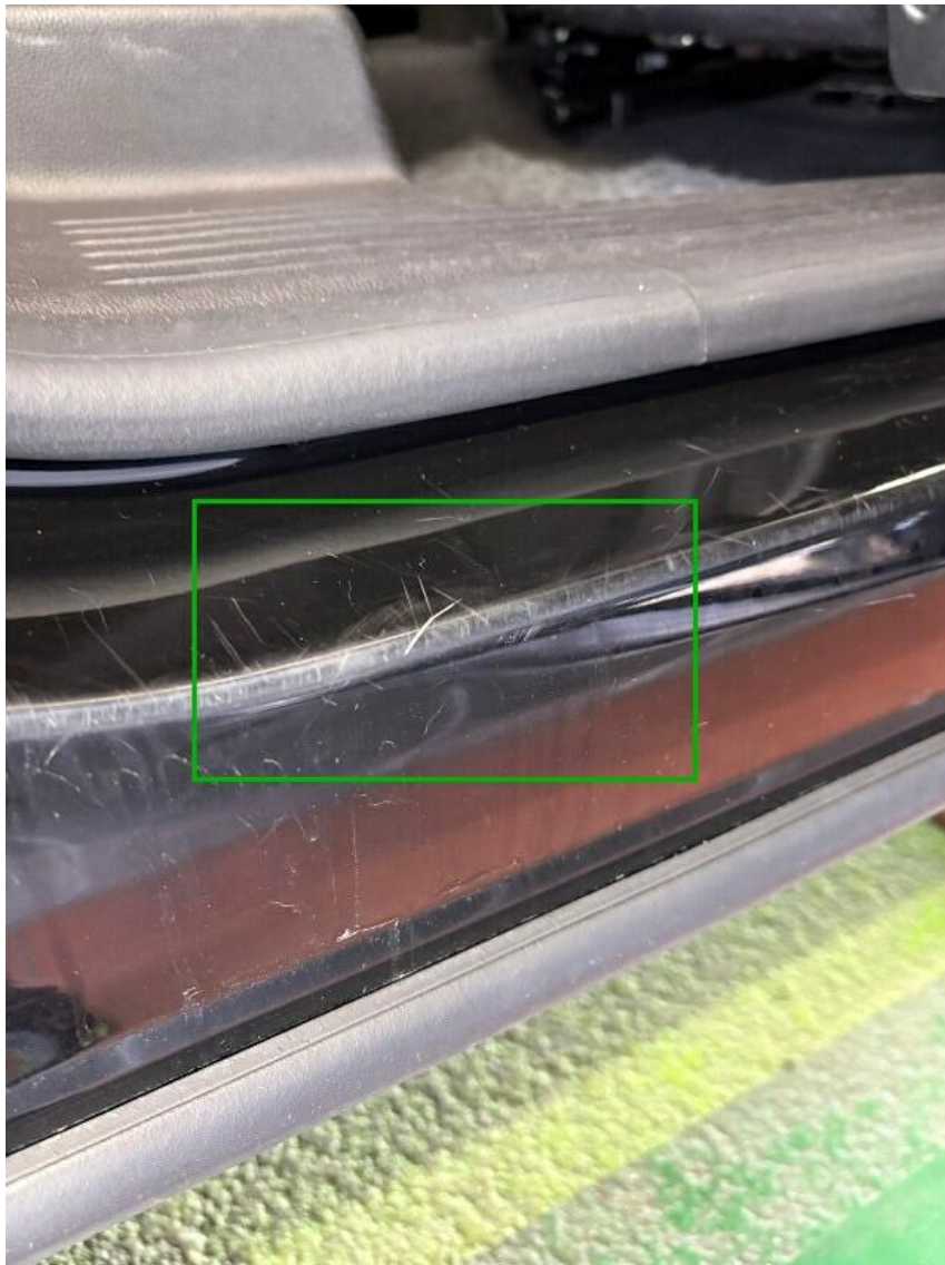
Bild 23 : Türeinstieg hinten rechts, zerkratzt
