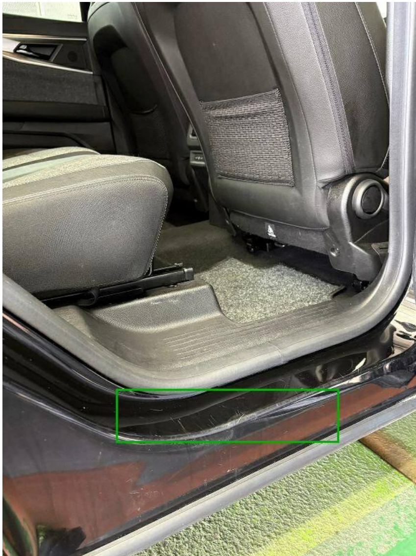
Bild 22 : Türeinstieg hinten rechts, zerkratzt
