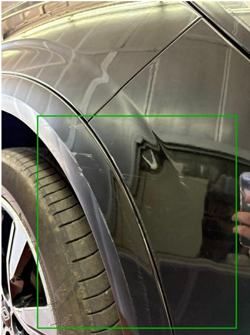
Bild 27 : Radlaufblende + Stoßfänger vorne, zerkratzt
