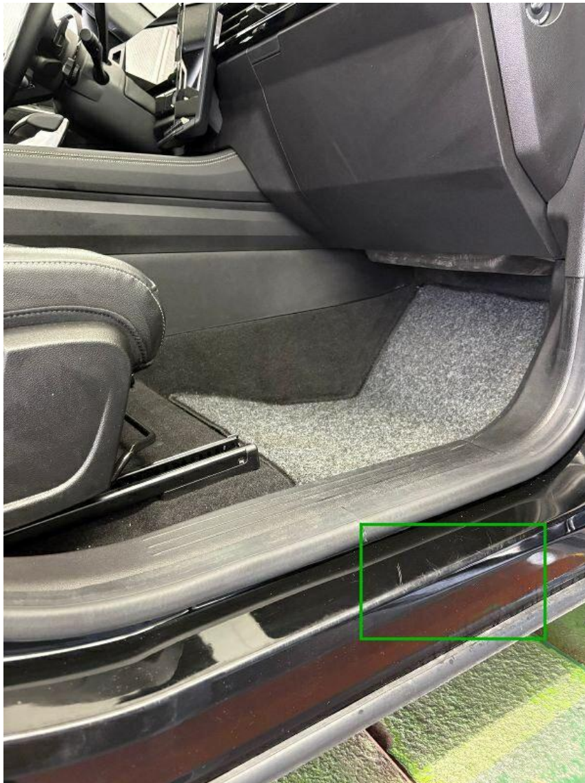
Bild 25 : Türeinstieg vorne rechts, zerkratzt
