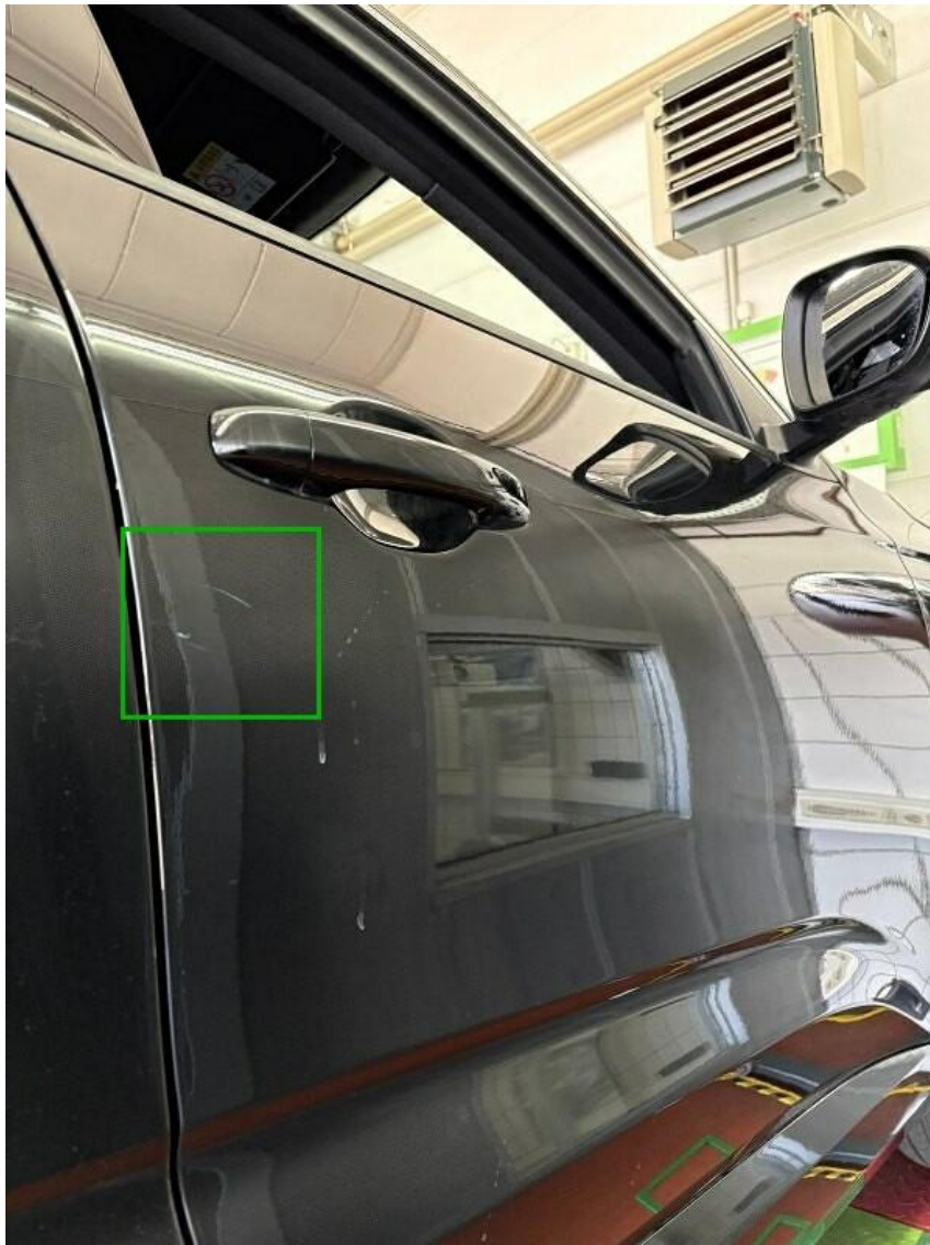
Bild 24 : Türe vorne rechts, zerkratzt
