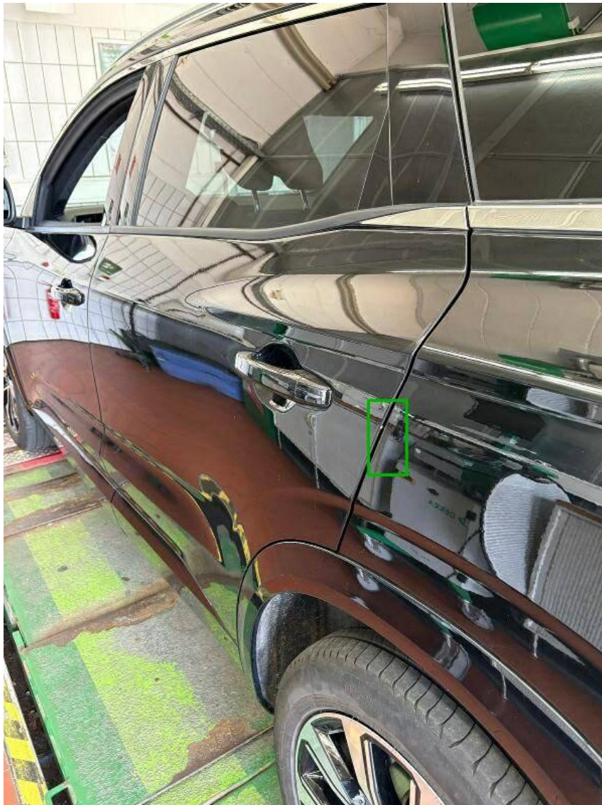
Bild 17 : Türe Hinten rechts, Türkante zerkratzt
