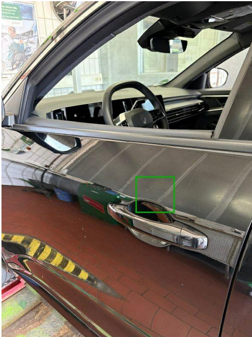
Bild 15 : Türe vorne links, zerkratzt
