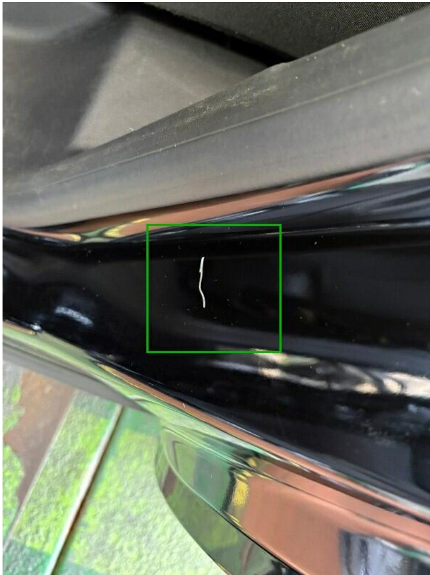
Bild 19 : Türeinstieg hinten rechts, zerkratzt
