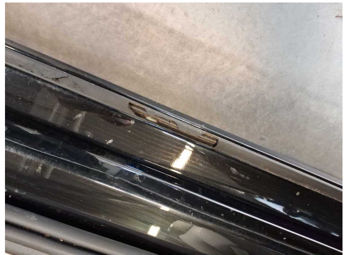
Damage 9: Door - front left side: Door seal - Broken / torn - Replace
