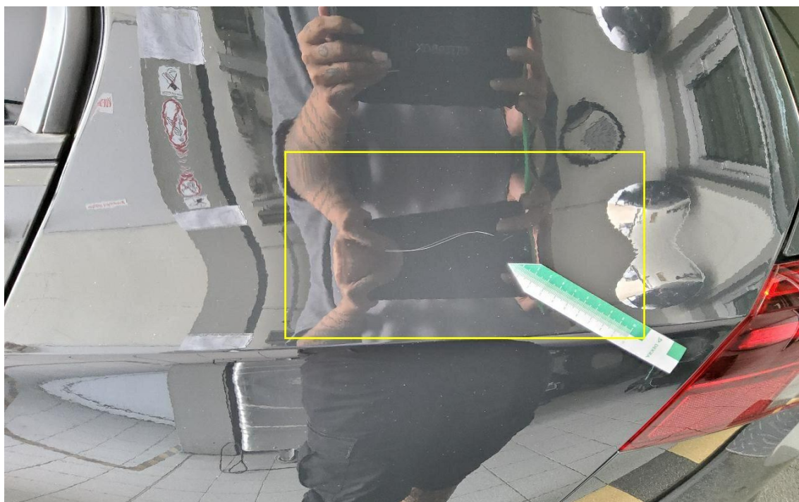
Bild 30 : Seitenwand hinten links Kratzer
