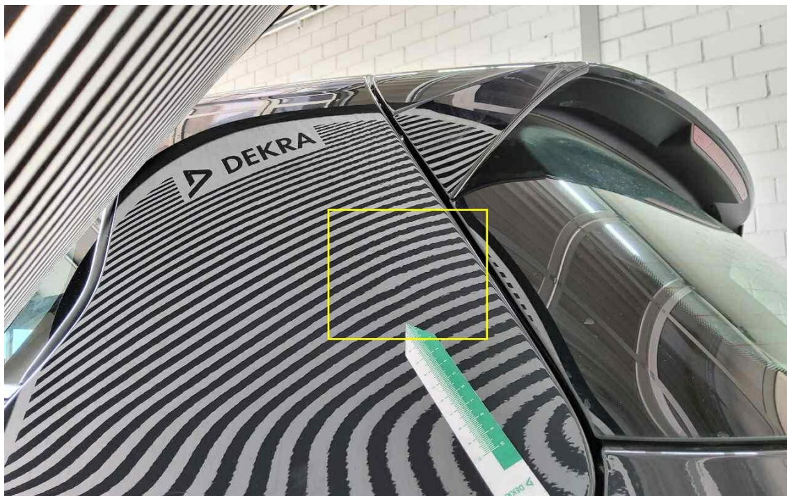
Bild 17 : Seitenwand hinten links mehrere Dellen
