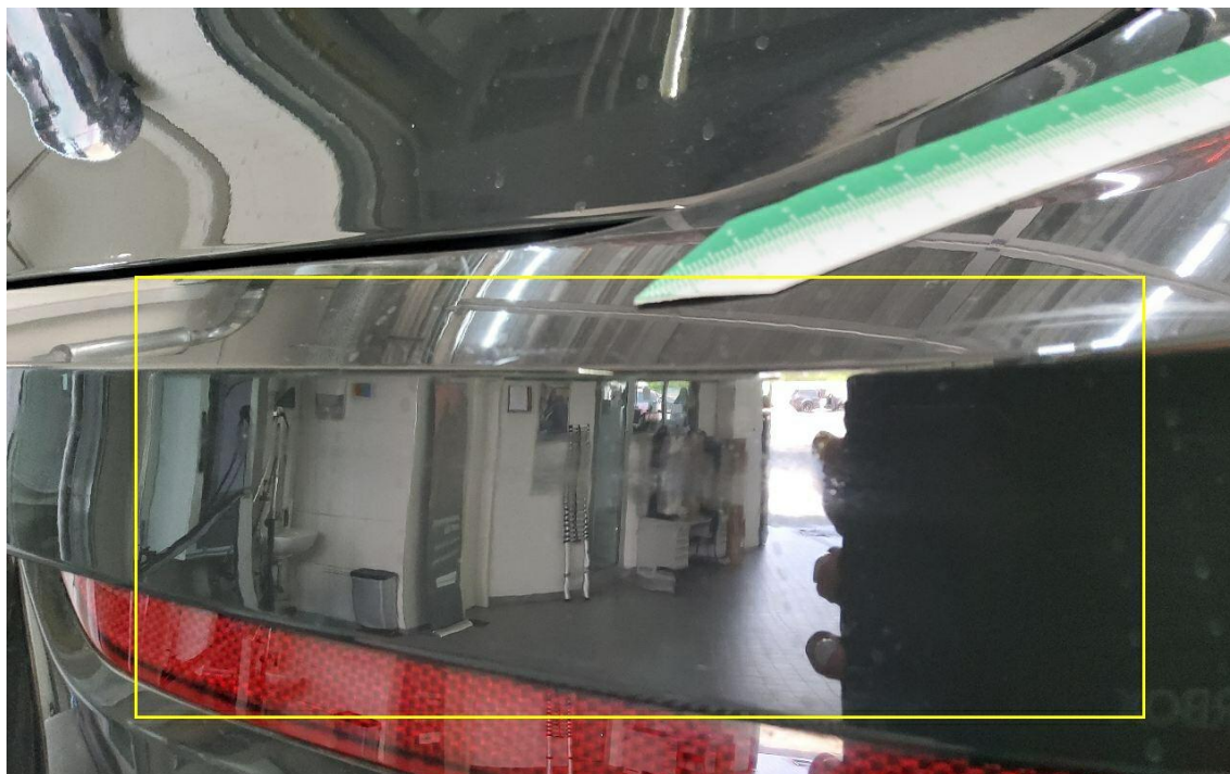
Bild 21 : Stoßfängerverkleidung hinten mehrfach verschrammt und eingedellt
