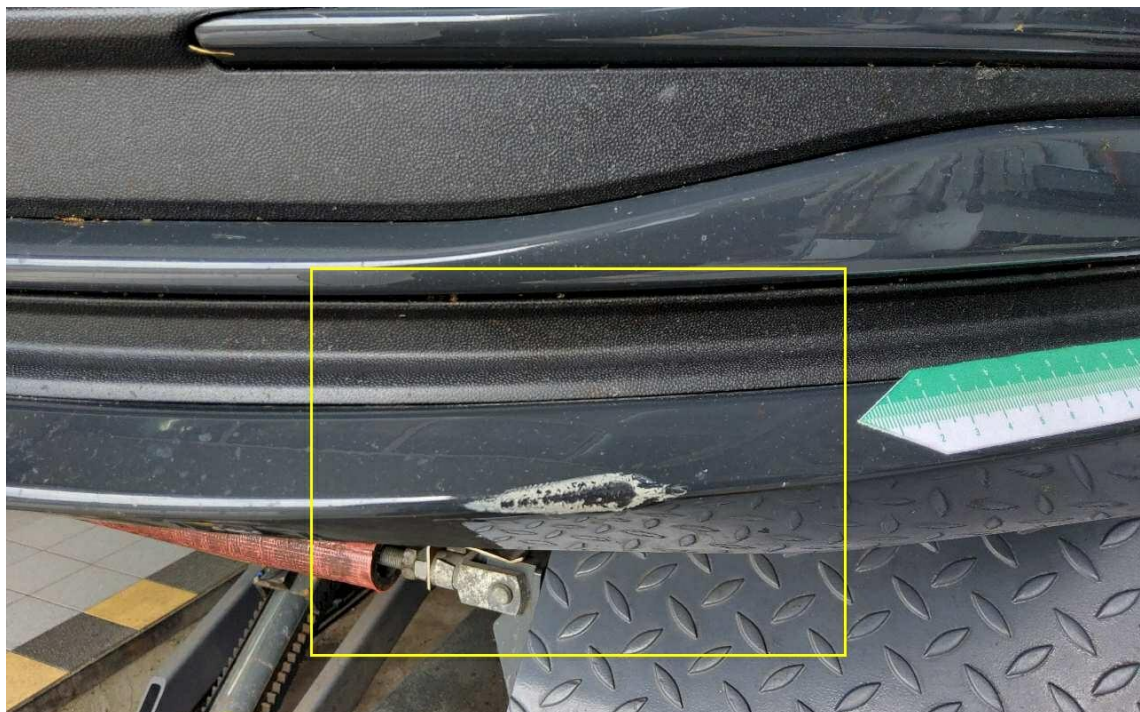
Bild 26 : Stoßfängerverkleidung vorne verschrammt
