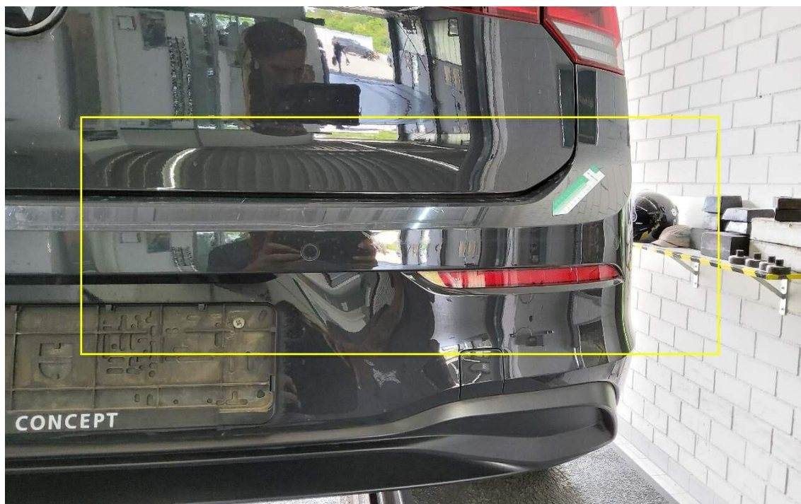
Bild 19 : Stoßfängerverkleidung hinten mehrfach verschrammt und eingedellt
