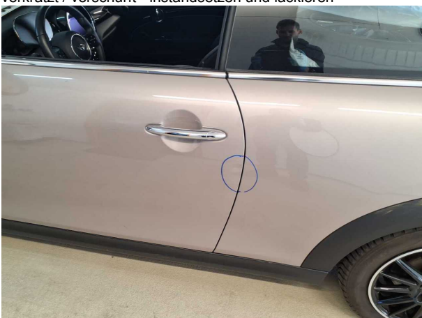
Beschädigung #4: Tür vorn links: Tür - Delle(n) - instandsetzen und lackieren
