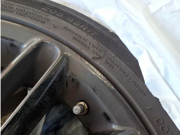
Beschädigung #2: 2.Radsatz: 2 Leichtmetallfelgen - verkratzt / verschürft - Wertminderung
