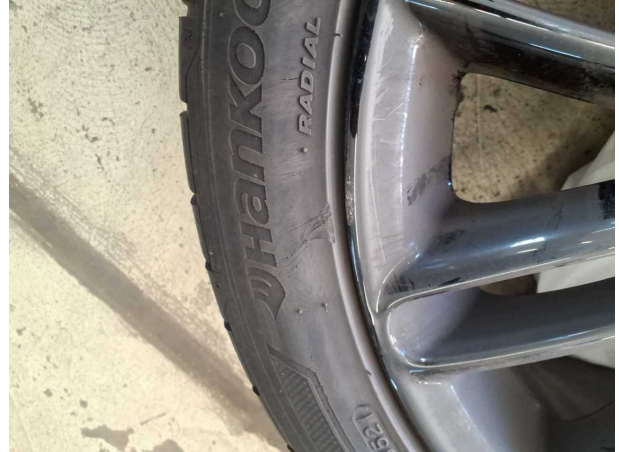
Beschädigung #2: 2.Radsatz: 2 Leichtmetallfelgen - verkratzt / verschürft - Wertminderung
