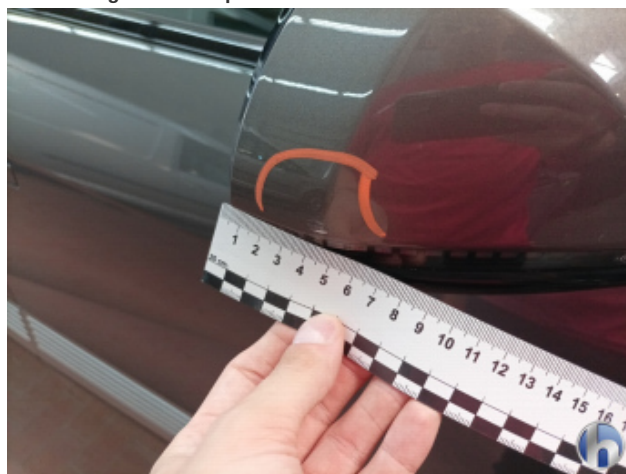
2. Außenspiegel Gehäuse - Rechts Beschädigt - Smart Repair
