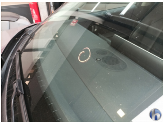
1. Windschutzscheibe Steinschlag - Smart Repair
