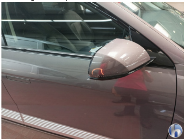
2. Außenspiegel Gehäuse - Rechts Beschädigt - Smart Repair
