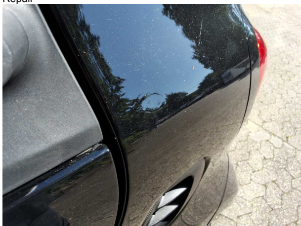
Beschädigung #2: Seitenwand links: Seitenwand - Delle(n) - sanft instandsetzen
