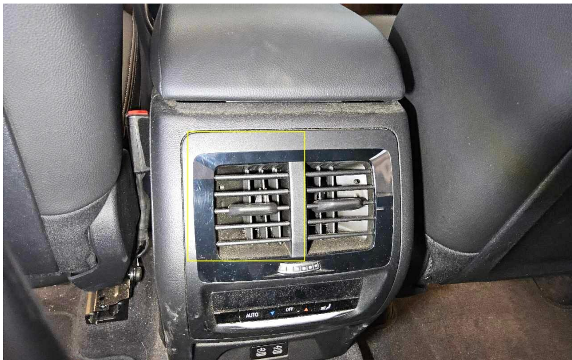
Bild 15 : Luftdüsen hinten gebrochen
