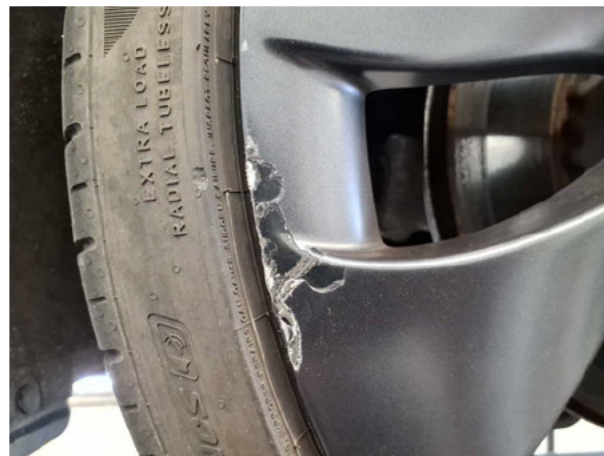
Beschädigung #7: Rad/Reifen: Leichtmetallfelge hinten links - Kratzer - erneuern
