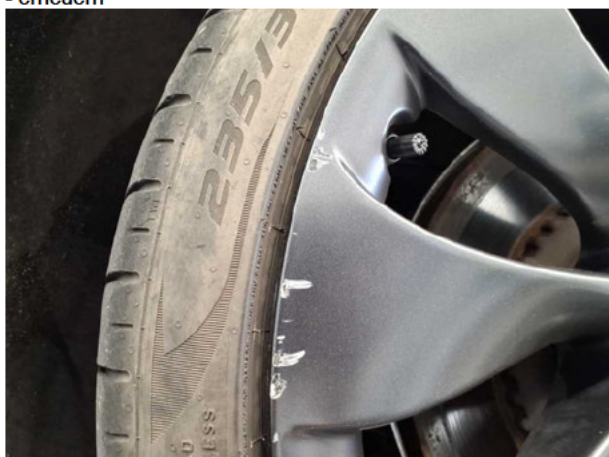
Beschädigung #7: Rad/Reifen: Leichtmetallfelge hinten links - Kratzer - erneuern
