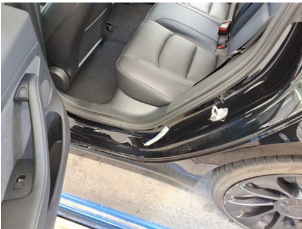
Beschädigung #6: Seitenwand links: Einstieg - Kratzer - Smart Repair
