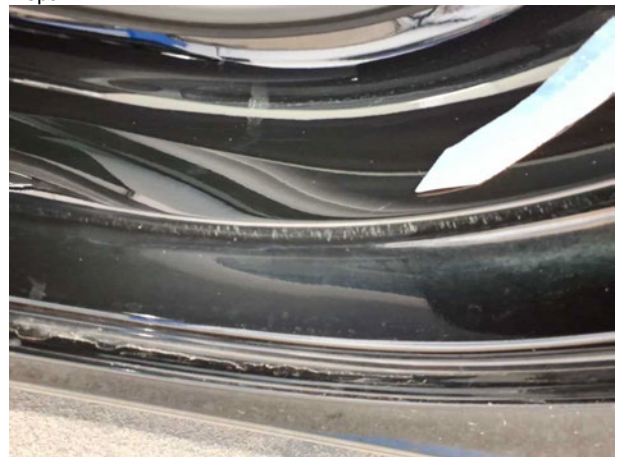
Beschädigung #6: Seitenwand links: Einstieg - Kratzer - Smart Repair
