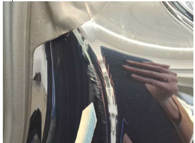
Beschädigung #6: Seitenwand links: Einstieg - Kratzer - Smart Repair
