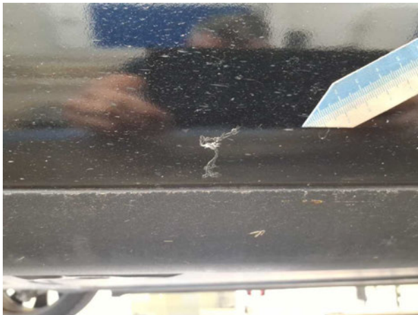
Beschädigung #3: Schweller rechts: Schweller - Kratzer - Smart Repair
