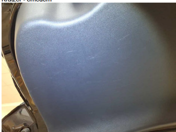
Beschädigung #1: Heckklappe/-tür: Verkleidung Standard unten - Kratzer - erneuern
