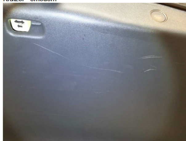
Beschädigung #1: Heckklappe/-tür: Verkleidung Standard unten - Kratzer - erneuern
