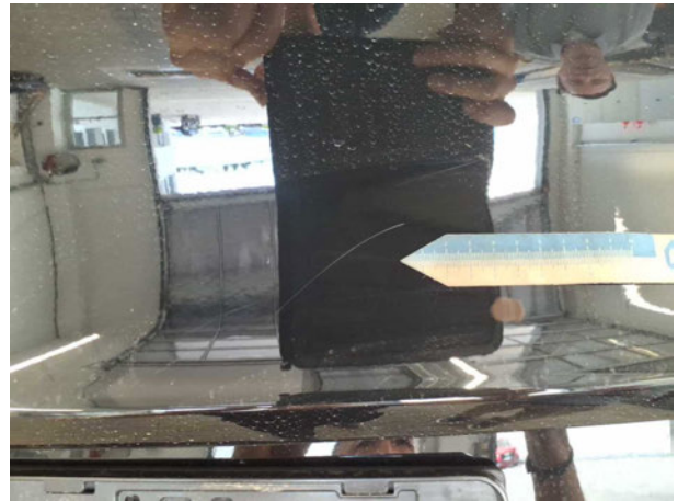
Beschädigung #5: Heckklappe/-tür: Heckklappe - Kratzer - Smart Repair
