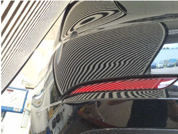
Beschädigung #8: Stossfänger hinten: Stossfänger hinten - verformt - erneuern
