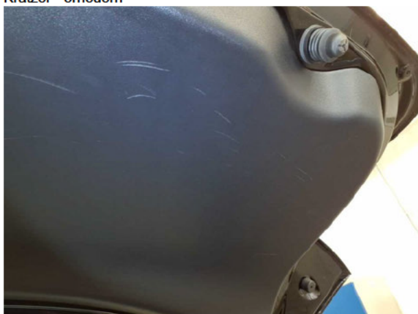
Beschädigung #1: Heckklappe/-tür: Verkleidung Standard unten - Kratzer - erneuern
