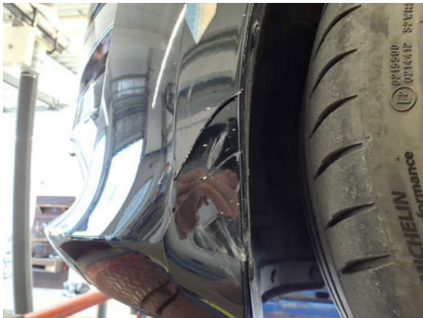
Beschädigung #9: Stossfänger vorn: Stossfänger vorn - gebrochen / gerissen - erneuern
