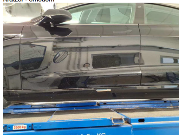
Beschädigung #2: Schweller links: Schweller - Kratzer - Smart Repair
