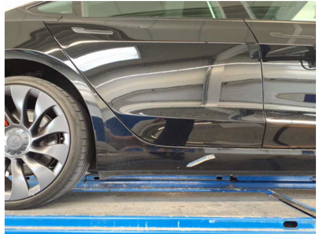
Beschädigung #3: Schweller rechts: Schweller - Kratzer - Smart Repair
