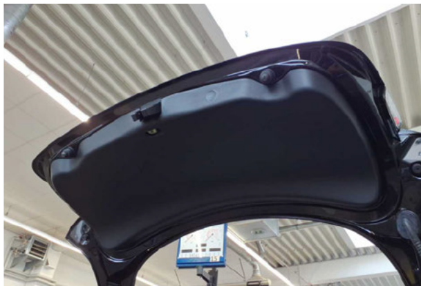
Beschädigung #1: Heckklappe/-tür: Verkleidung Standard unten - Kratzer - erneuern
