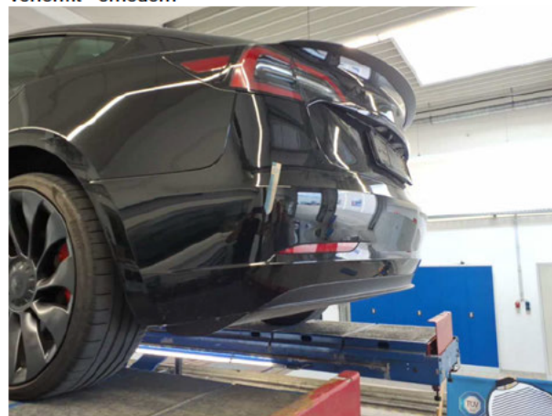
Beschädigung #8: Stossfänger hinten: Stossfänger hinten - verformt - erneuern
