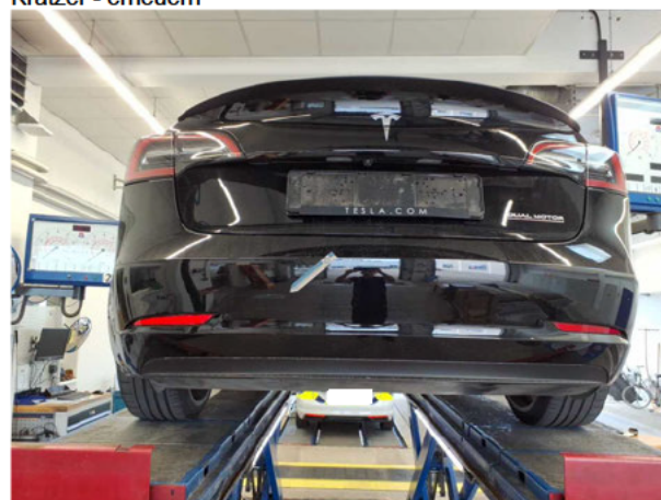
Beschädigung #8: Stossfänger hinten: Stossfänger hinten - verformt - erneuern
