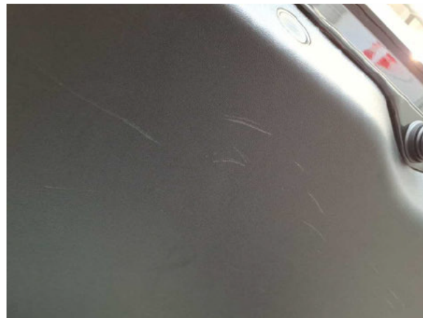
Beschädigung #1: Heckklappe/-tür: Verkleidung Standard unten - Kratzer - erneuern
