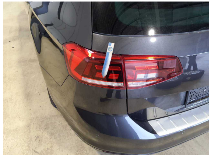
Damage 13: Tail light: Tail lamp - left side (außen) - Broken / torn - Replace
