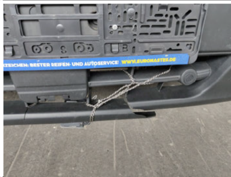
Stoßfänger unterhalb / Vorne / Gebrochen
