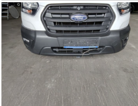
Stoßfänger unterhalb / Vorne / Gebrochen
