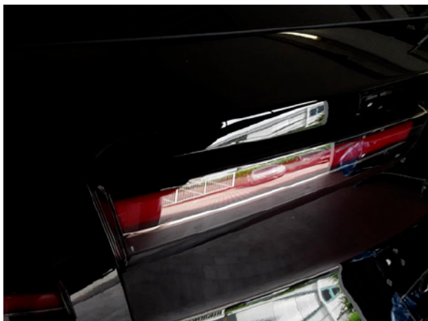
Beschädigung 1: Heckleuchte: Heckleuchte links - verkratzt / verschürft - erneuern
