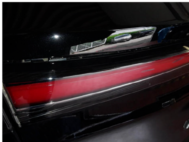
Beschädigung 1: Heckleuchte: Heckleuchte links - verkratzt / verschürft - erneuern
