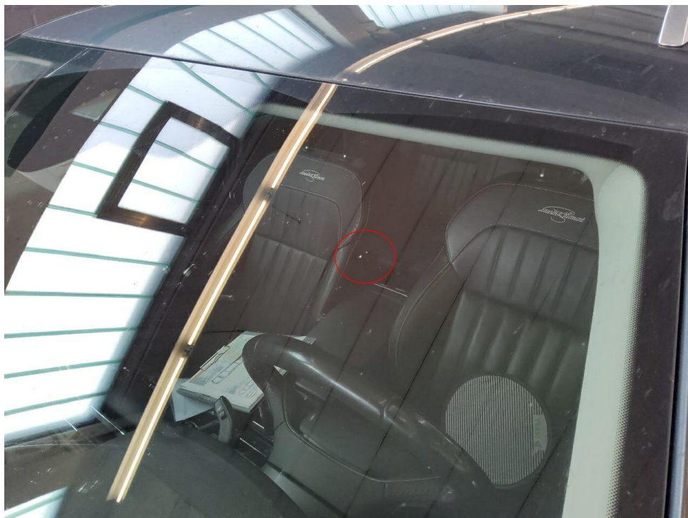
Bild 20 : Frontscheibe, Steinschlagschaden Sichtfeld
