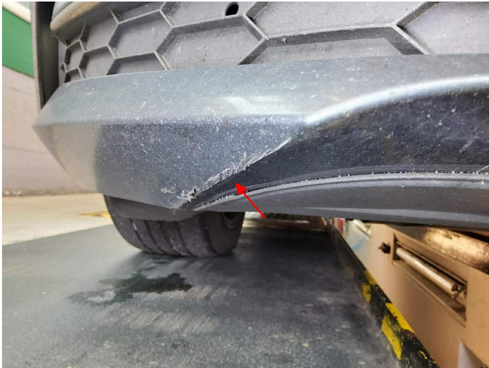
Bild 15 : Stoßfänger vorne Lackierung, verschrammt, lackieren mit Lackaufbau
