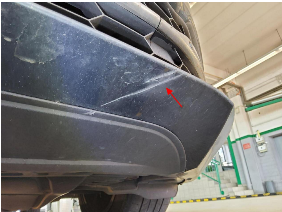
Bild 16 : Stoßfänger vorne Lackierung, verschrammt, lackieren mit Lackaufbau
