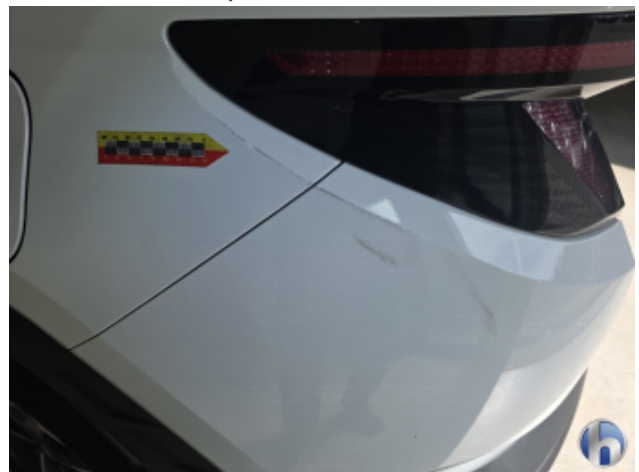
2. Seitenwand - Hinten - Links Kratzer - Smart Repair
