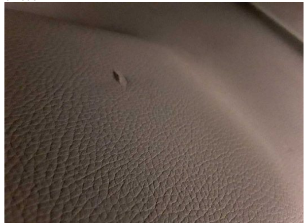
Beschädigung #6: Sitz vorn: Sitzkastenverkleidung links - beschädigt - erneuern
