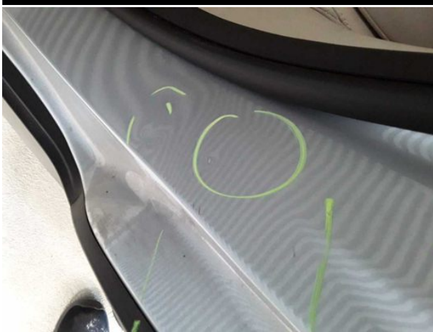
Beschädigung #11: Seitenwand links: Einstieg - Delle / Lackschaden - Smart Repair
