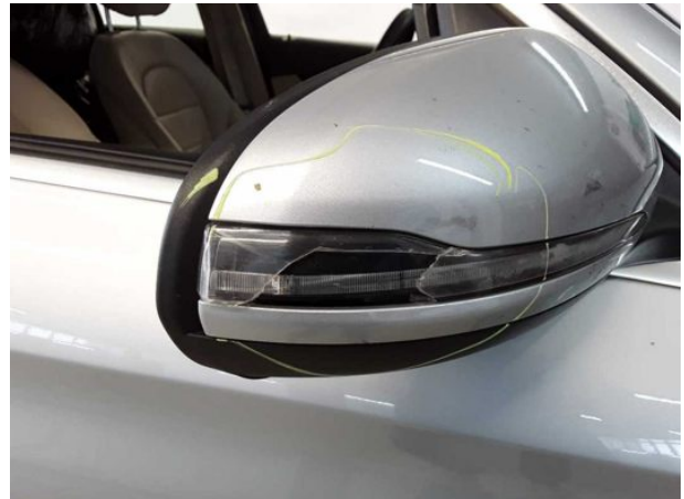
Beschädigung #5: Blinkleuchte: Spiegel rechts - beschädigt - erneuern
