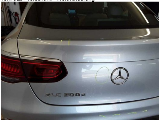
Beschädigung #9: Heckklappe/-tür: Heckklappe - Delle / Lackschaden - Smart Repair
