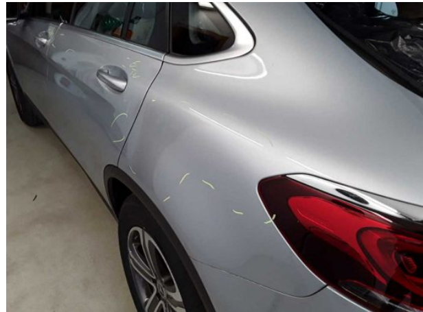
Beschädigung #16: Seitenwand links: Seitenwand - verkratzt / verschürft - instandsetzen und lackieren
