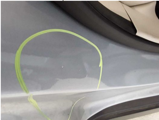
Beschädigung #12: Seitenwand rechts: Einstieg - Delle / Lackschaden - instandsetzen und lackieren
