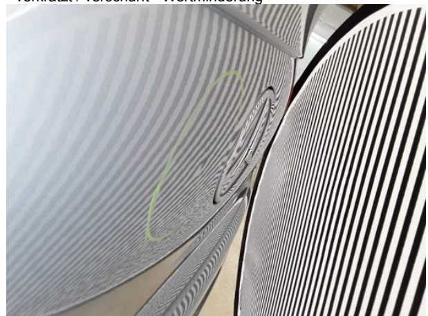
Beschädigung #9: Heckklappe/-tür: Heckklappe - Delle / Lackschaden - Smart Repair
