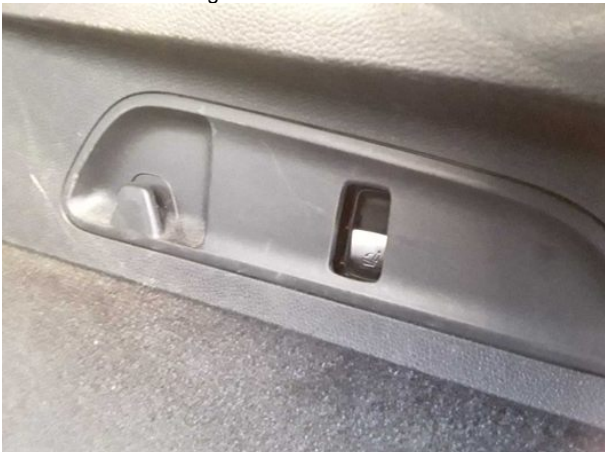
Beschädigung #4: elektrisches System: Schalter (Rücksitz lose) - de-/montieren
