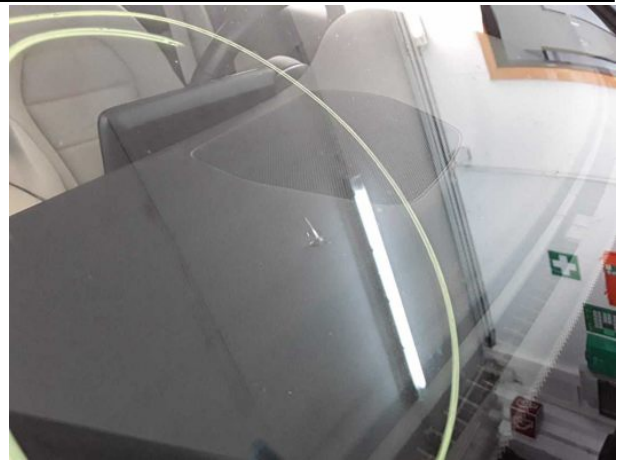
Beschädigung #17: Verglasung: Frontscheibe (Rissbildung) - erneuern
