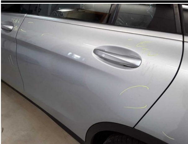
Beschädigung #15: Tür hinten links: Tür - verkratzt / verschürft - instandsetzen und lackieren
