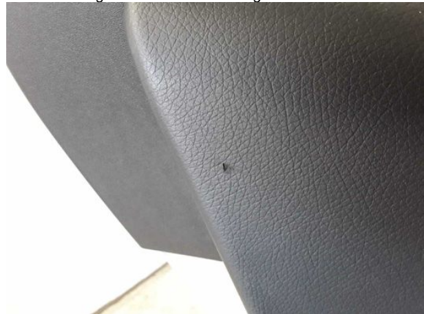
Beschädigung #10: Verkleidungen/Abdeckungen: Türverkleidung hinten links - beschädigt - erneuern
