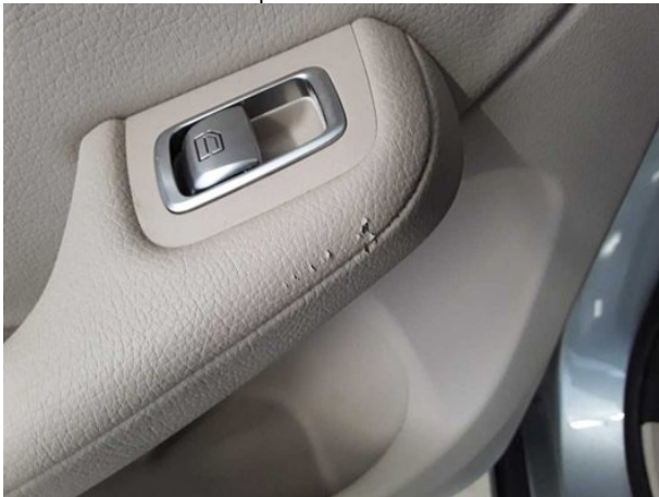
Beschädigung #10: Verkleidungen/Abdeckungen: Türverkleidung hinten links - beschädigt - erneuern
