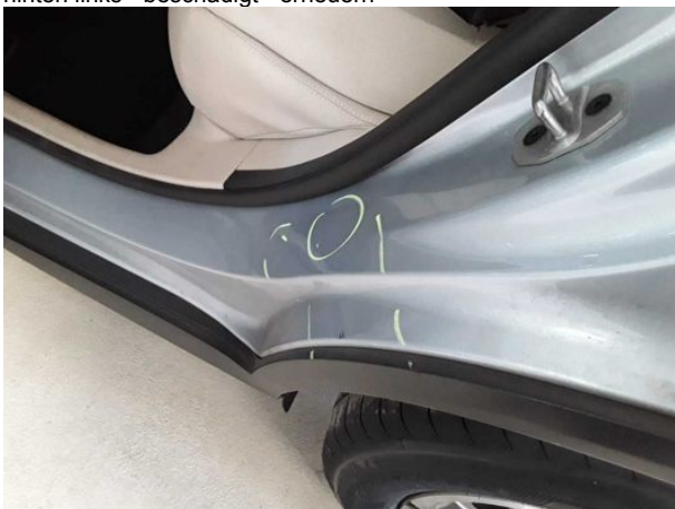
Beschädigung #11: Seitenwand links: Einstieg - Delle / Lackschaden - Smart Repair
