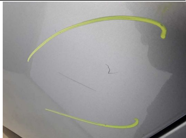
Beschädigung #15: Tür hinten links: Tür - verkratzt / verschürft - instandsetzen und lackieren
