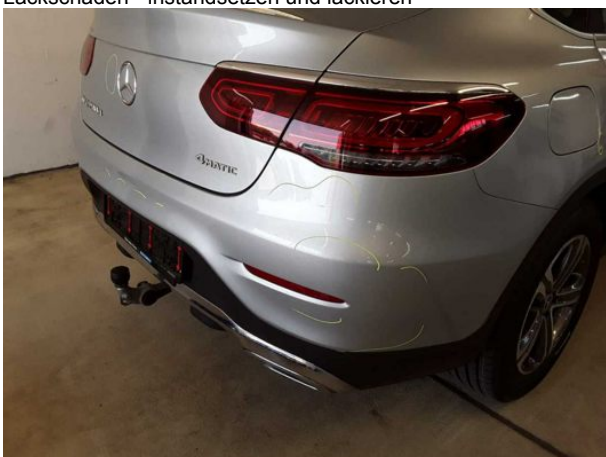
Beschädigung #13: Stossfänger hinten: Stossfänger hinten - Kratzer - instandsetzen und lackieren
