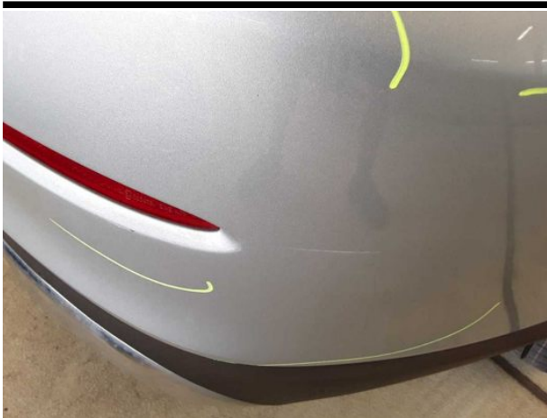
Beschädigung #13: Stossfänger hinten: Stossfänger hinten - Kratzer - instandsetzen und lackieren
